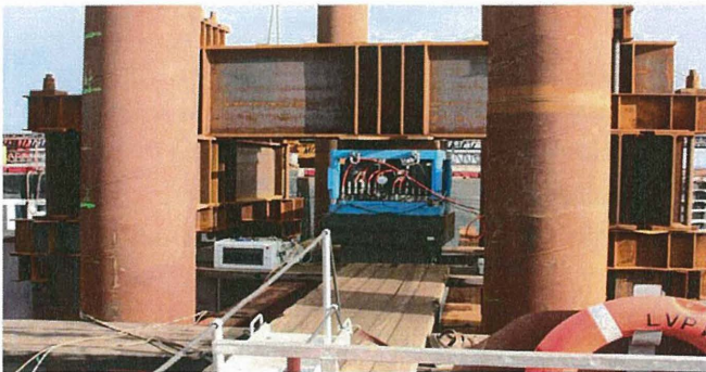
Bild 8: Aufbau statische Probelastung; IPM
