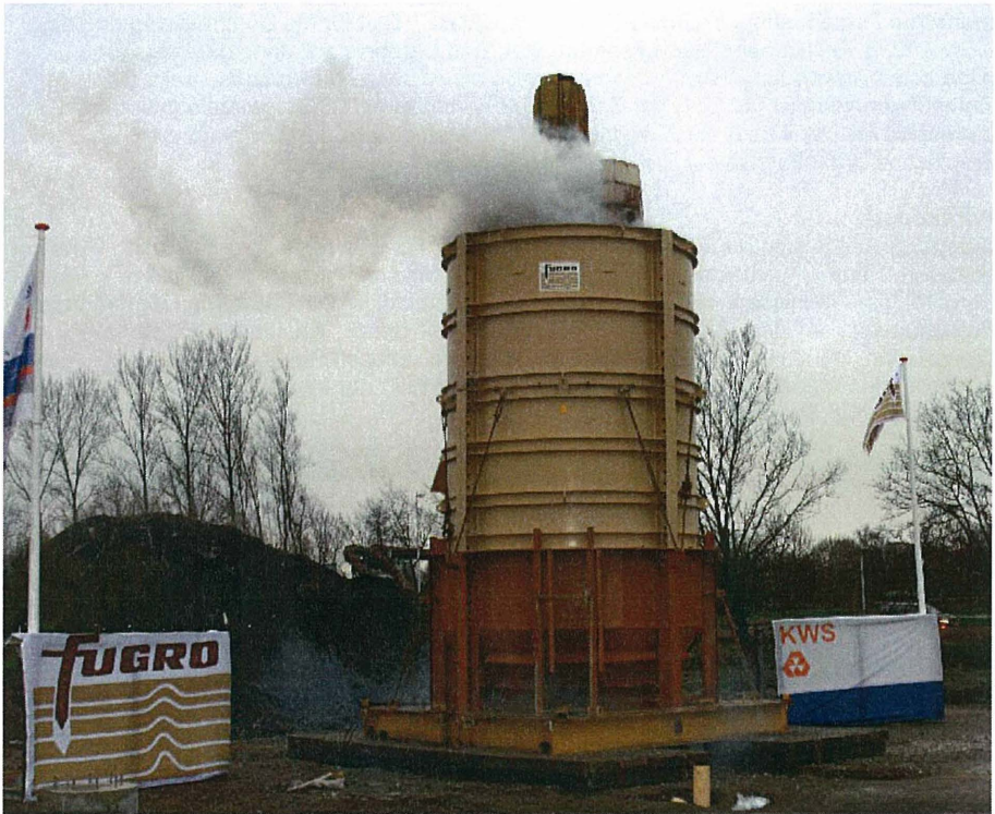
Abbildung 1, 16 MN statnamische Probelbelastung in Vleuten, Niederlande.
