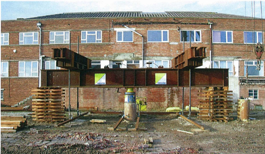
Abb. 11: Aufbau der statischen Probelastung
