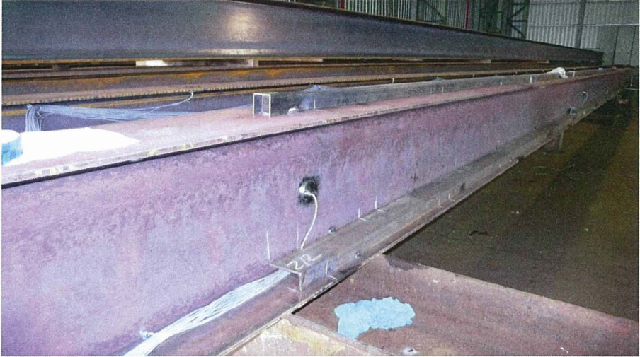
Abb. 8: Mit Messgebern bestückter Schrägpfahl
