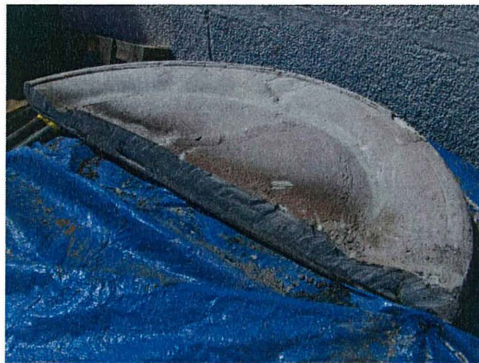
Bild 14: Aufgeschnittenes Hubkissen nach Zementverfüllung
