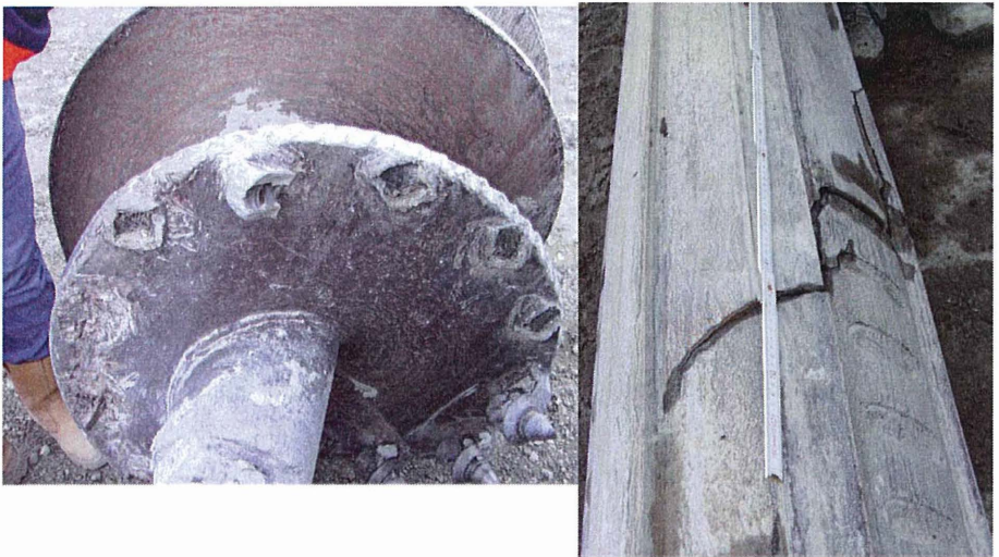
Abb. 9: Verschlossene Progressivschnecke und Kellystange
