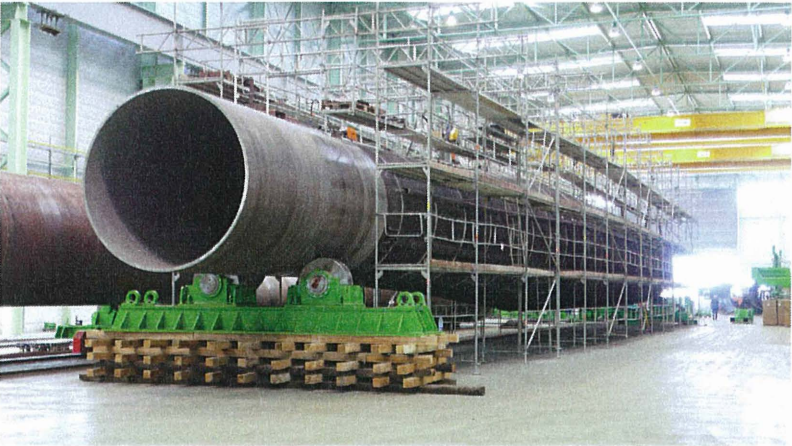
Eingerüsteter Monopile bei EEW SPC in Rostock
