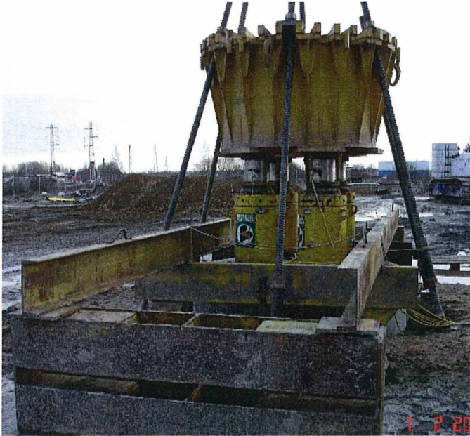
Abb. 6: Versuchsaufbau für den Probepfahl mit D = 1,0\text{ m}
