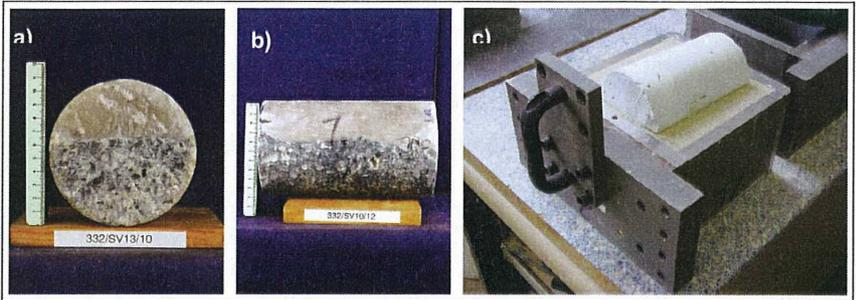
Abb. 6: Prüfkörper vor dem Versuch a) Stirnfläche und b) laterale Ansicht; c) vorbereiteter und in unterem Scherkasten in hochfestem Mörtel eingegossener Prüfkörper.
