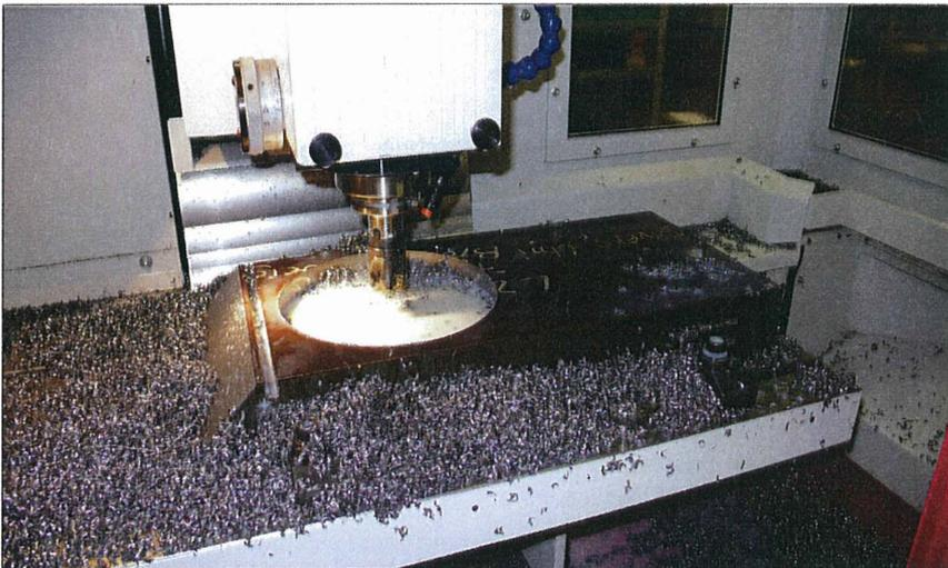
Abbildung 2: Herstellung der GEMSOGS in der CNC-Fräse am IGB-TUBS
