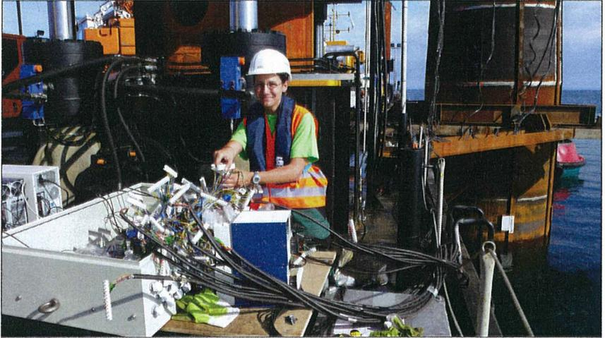
**Abbildung 20: Anschließen der Kabel an Datenerfassungsanlage**
