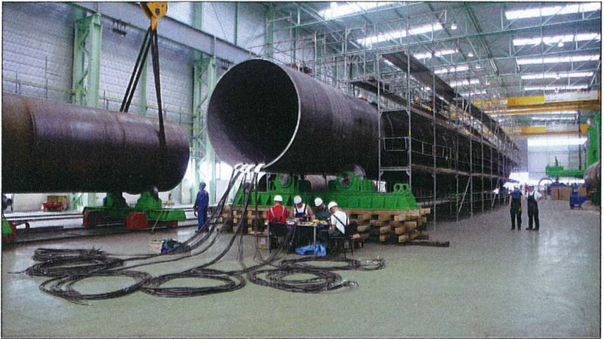
Abbildung 6: eingüsteter Monopile bei EEW SPC in Rostock
