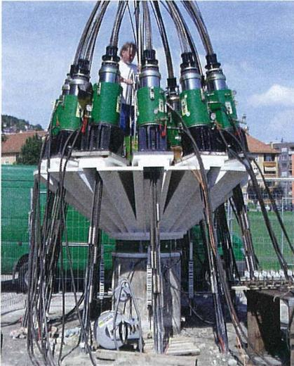
**Abb. 8: Pfahlbelastungsversuch mit Gleitmikrometermessung**
