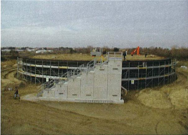
**Abb. 4: Venezia, Bocca di Lido: Konsolidationsversuch;
