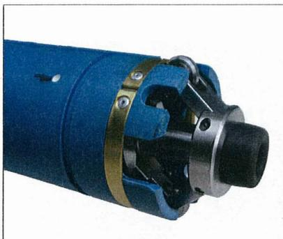
**Abb. 5:** Fußteil der Streckenmesssonde in Messposition, Anschlag der Führungsrollen am Messanschlag.
