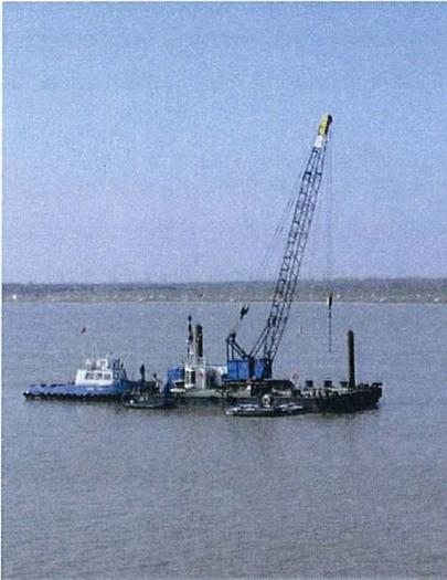
Abb. 2.4-1: Stelzenponton 12 \* 24 m mit Schlepper und Kran
