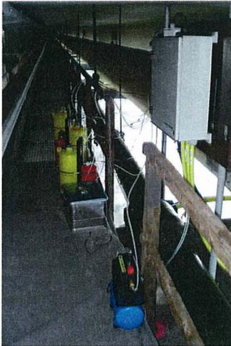
Abb. 2.3-4: Laufgang unter der Brücke mit Messschrank und Messaufbau Linienvermessung
