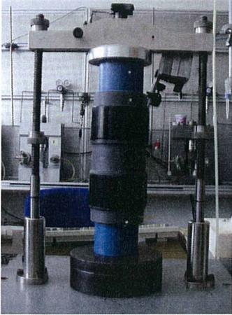
**Abb. 12:** Druckversuch Muffe/Rohr
