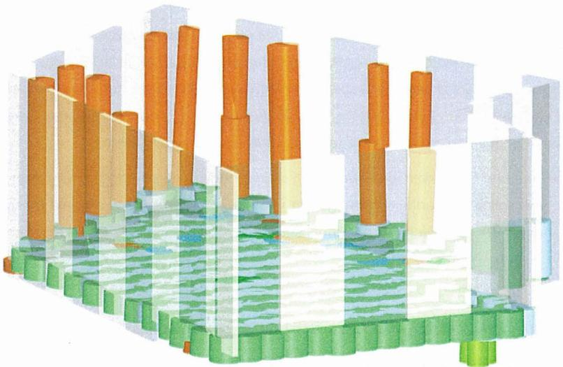
**Abbildung 2: Visualisierung einer Düsenstrahlsole**
