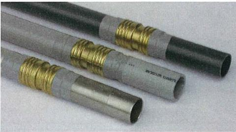
**Abb. 2. Gleitmikrometer- Messrohre**
