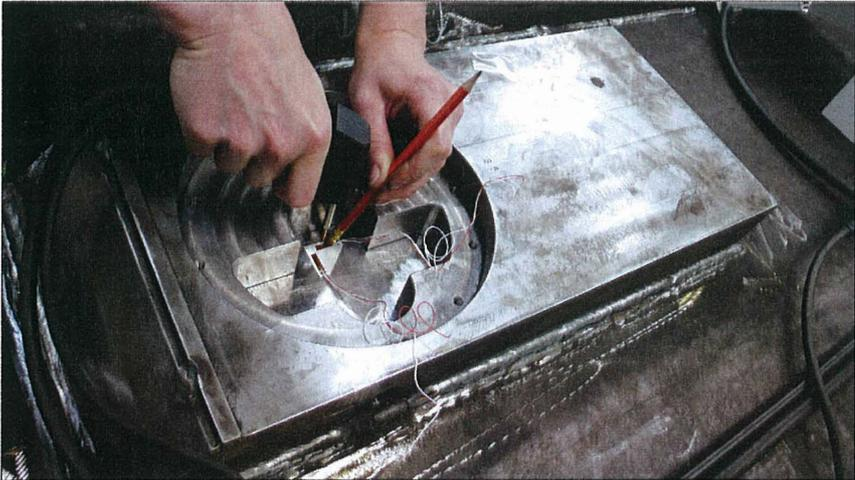
**Abbildung 8: Punktschweißen eines Dehnungsmessstreifen**
