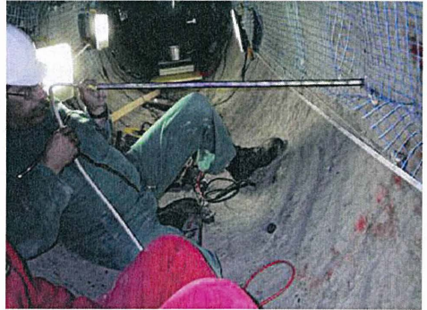
Abb. 4 Elektrodenanordnung und Installation im Mont Terri Ventilationsversuch
