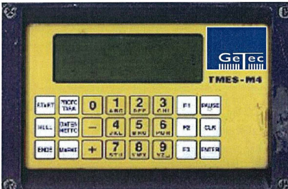
Abbildung 2: M4 Bedienungseinheit und digitale Anzeige der Herstellparameter am Bohrgerät
