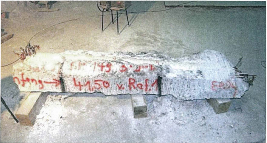
Abb. 13: Freigelegter Steinsalzblock mit eingebetteter Monitorstation SM149-3
