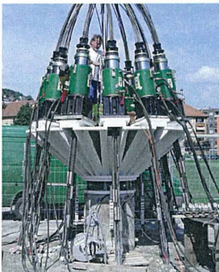
Bild 7: Versuchsaufbau und Gleitmikrometermessung
