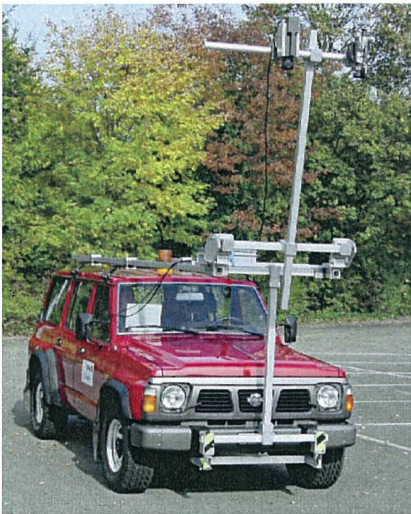
Abb. 4.14: Rechts: Mobile Infrarot-Messanlage der Eidgenössischen Material- und Prüf-anstalt (EMPA) für die Untersuchung von Strassen- und Brückenbelägen (Stimolo, 2003), links: IR-Bauwerksscanner auf einem mobilen Trägerfahrzeug für den Einsatz bei Tunnelbauwerken (irscat ag)
