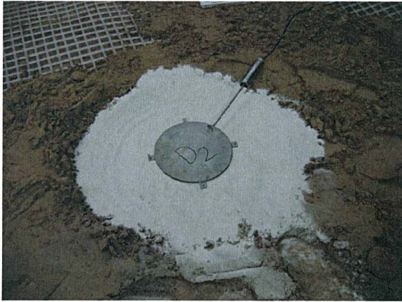
Abb. 20: Ummantelung der Druckmessdosen mit Feinsand
