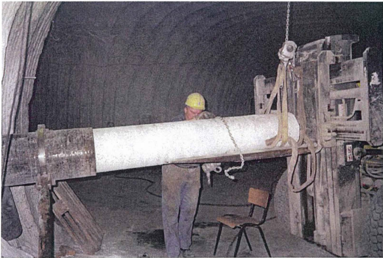
Abb. 11: Überbohren und Gewinnung einer im Gebirge installierten Spannungsmonitorstation
