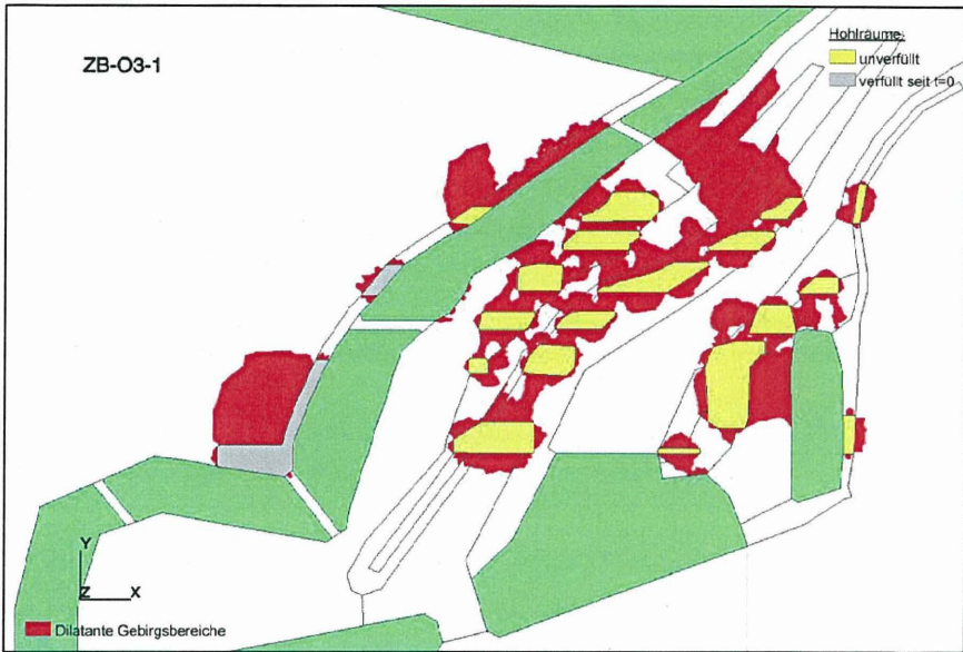
Abb. 10: Berechnete dilatante Bereiche im Zentralbereich des ERA Morsleben
