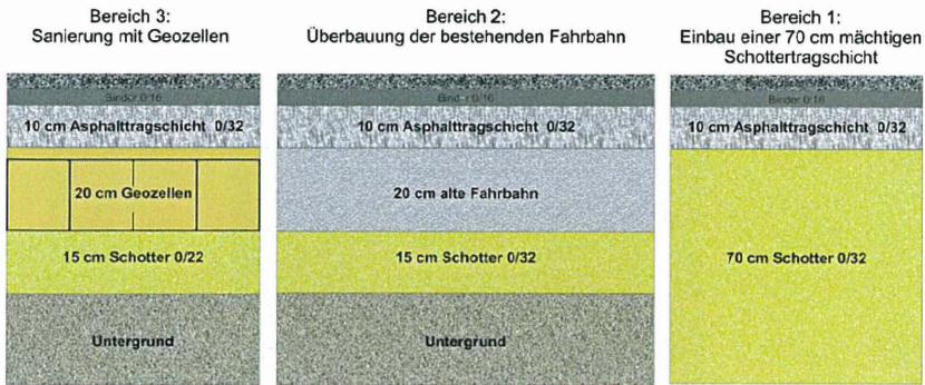
Abb. 3: Unterschiedliche Sanierungsabschnitte über die Fahrbahnbreite
