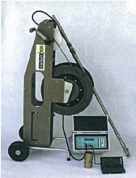
Bild 8: Messausrüstung für Gleitmikrometer
