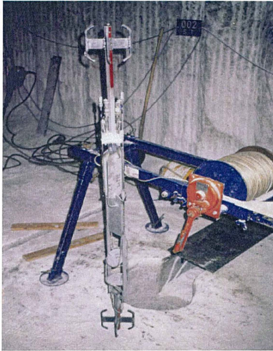
Abb. 3: Monitorstation mit zwei rechteckigen und zwei kreisförmigen Gebern
