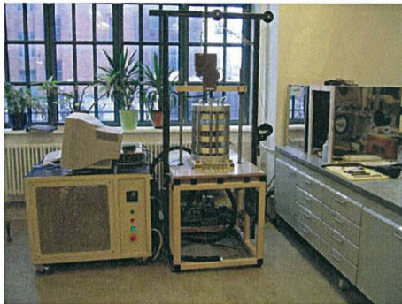
Bild 9: Gesamtansicht des Resonant-Column/Torsional-Shear Versuchsstandes
