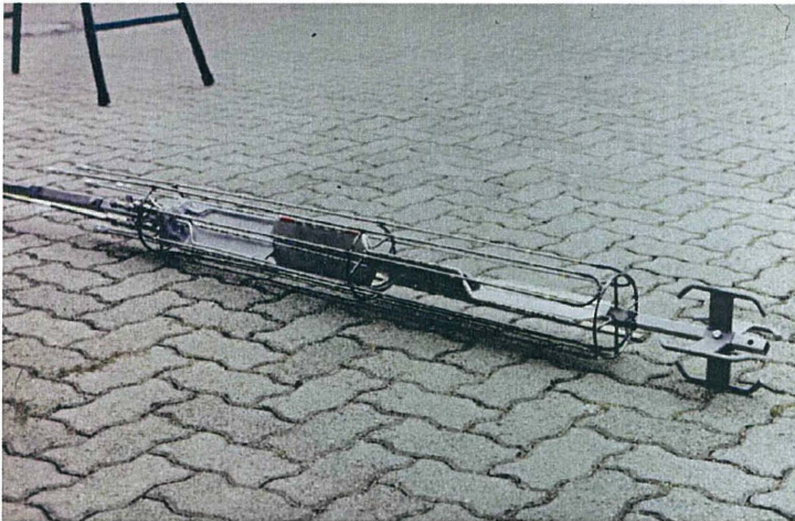
Abb. 2: Standardausführung einer 4-Komponenten-Spannungsmonitorstation mit vier quer zur Sondenachse messenden Spannungsgebern
