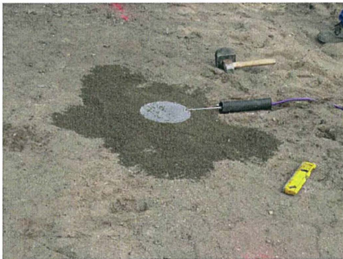
Abb. 9: Ummantelung der Erddruckmessdosen mit Feinsand
