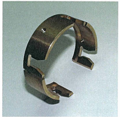
Abb. 4: Metallring aus Messing mit Messanschlag
