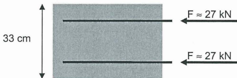
Bild 22: Skizze des Querschnitts durch die Tunnelschale
