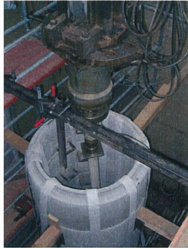
Abbildung 4.8: Belastungsversuch eines ungestützten Verbundpfahles (GEWI 28)
