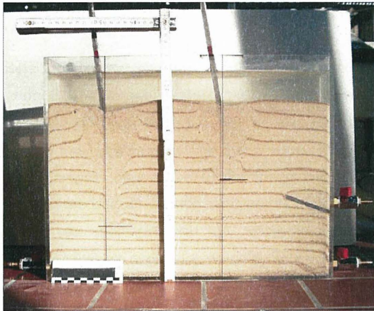
Abbildung 5: Modellversuch zu zyklisch belasteten Pfahlgründungen
