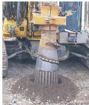
Bild 6: Verdrängerkopf System HARTUNG (Quelle: BAUER Maschinen GmbH).
