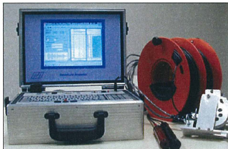
Bild 7: Ultraschallmessgerät (Cross-Hole Analyzer CHA) und Sensoren
