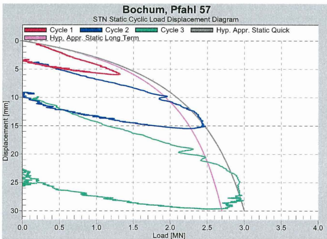
Abb. 8: Statische Lastsetzungsdiagramm fur drei Zykusse mit hyperbolische Annäherung und Korrektur für Belastungsabhängigkeit der Boden
