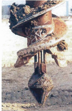
Bild 7: Verdrängerkopf CMC-Säulen System MENARD (Quelle: BVT DYNIV GmbH).
