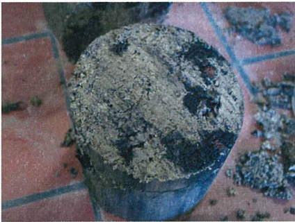
Abbildung 4.3: Bodenprobe der Weichschicht; strukturfester Alm (hell) mit Einlagerungen bestehend aus fasrigem Torf (dunkel)
