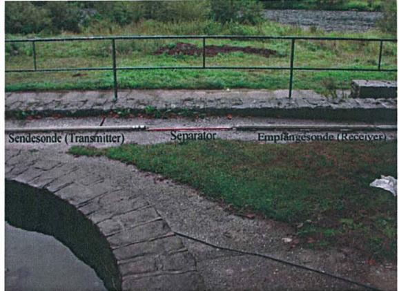
**Abb. 4:** Bohrloch-Radarsondenkonfiguration im Reflexionsmodus
