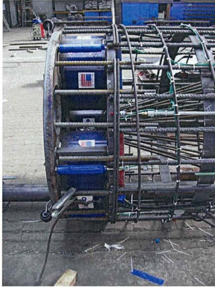
Bild 8: Osterberg-Zellenebene und Köcher für das Betonierrohr
