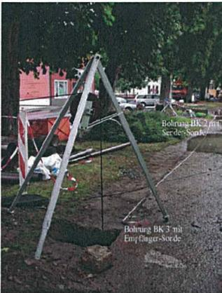
**Abb. 5:** Messung im Crosshole- oder tomographischen Modus
