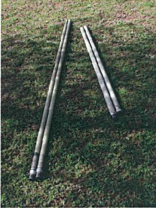
**Abb. 3:** 22 MHz und 100 MHz-Bohrloch-Radar-Messsonden
