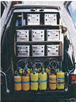
Abb. 8: Heckkladraum des Messfahrzeugs
