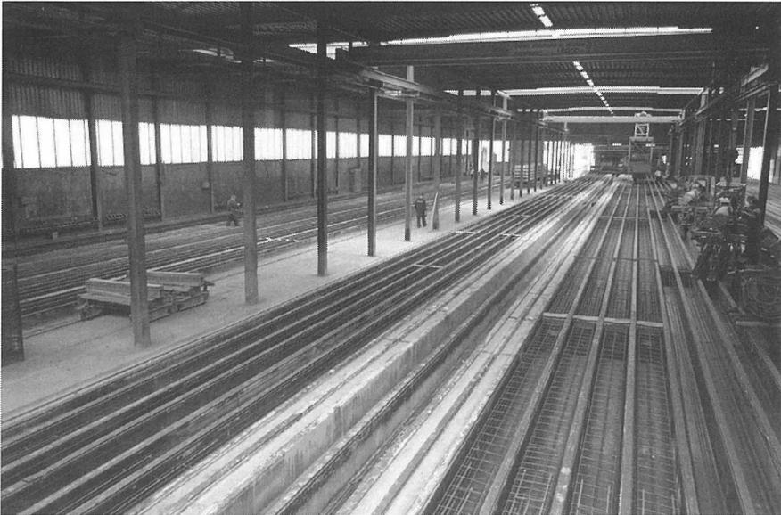
Abbildung 4: Formenfeld bei dem System der langen Bank
