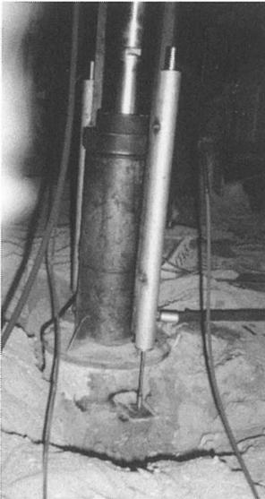
*Bild 6: Belastungseinrichtung Modellversuche Vilnius*
