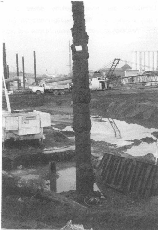
Bild 4: Freigelegter RI-Pfahl nach dem Zugversuch (GUD, 1997)
