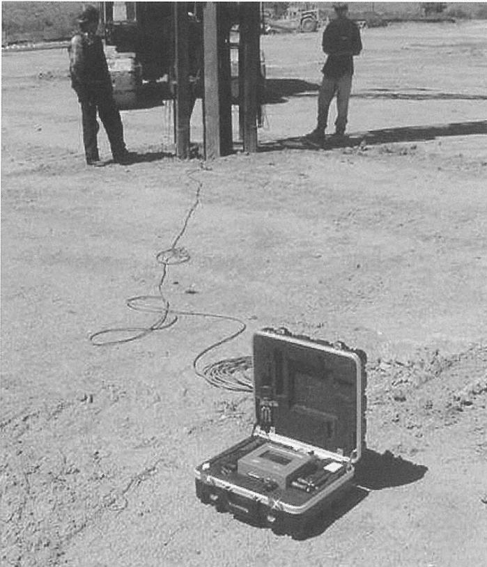
**Bild 5: Rammpfähle: PDA mit Telefonverbindung im Einsatz**
