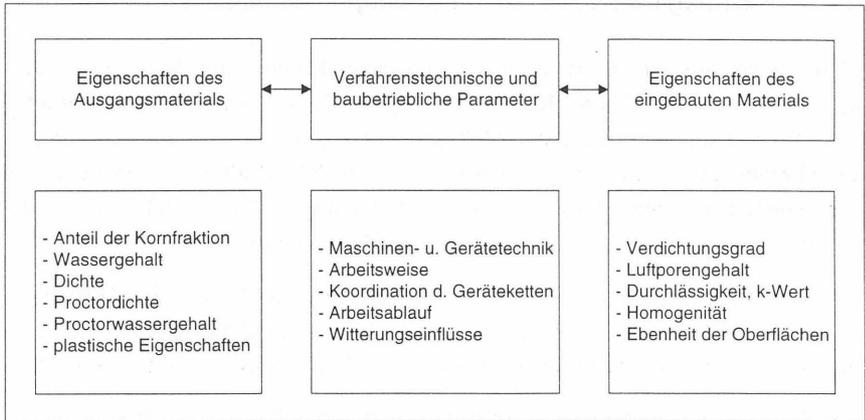
Abb. 5: Wechselwirkung zwischen Material und Verfahrenstechnik [9]
