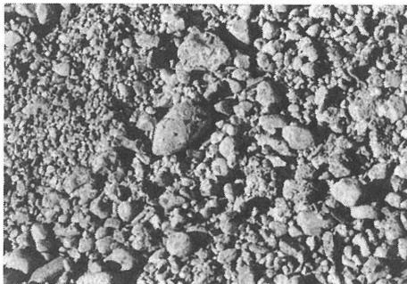
Abb. 9: In der Entsandungsanlage aus der Arbeitssuspension abgetrennter Bodenaushub.
