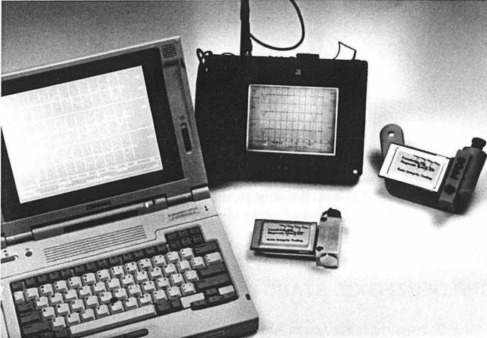
Bild 5: SIT-Gerät mit PCMCIA-Karte, basierend auf einem Notebook-PC oder einem "Hard Body" Computer.
