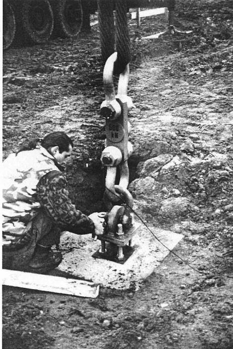
Bild 1: Zugpfahl mit Öse und Zugkraftmeßdose
