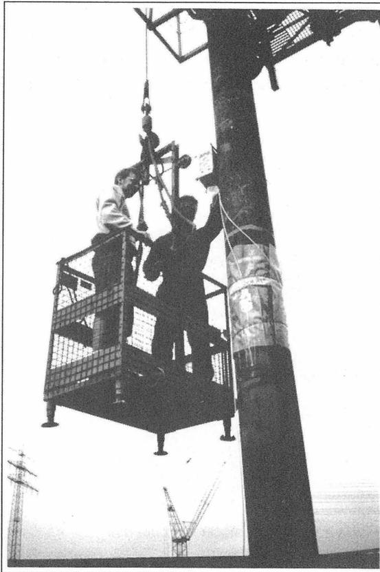
Bild 11: Verdrängungsrohr mit Dehnungsmeßstreifen und A-D Wandler
