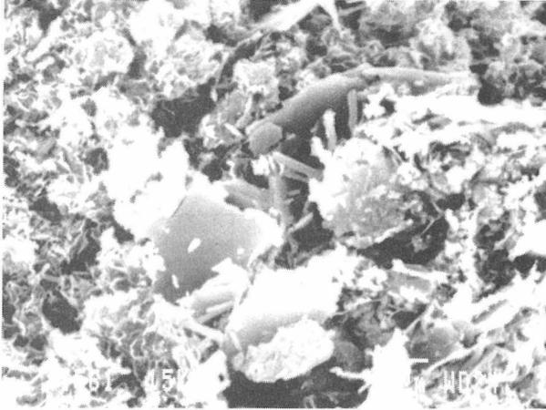
Bild 27: gestauchte Na-Dichtwandmasse bei 5.000-facher Vergrößerung
