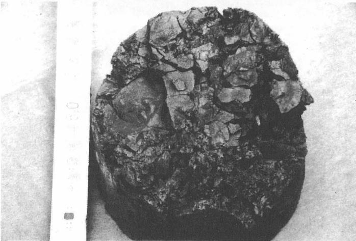
**Bild 46:** Durch Frost-Tau-Wechsel und Wassereinfluß vernäßtes und in Partikel zergliedertes Material (Fläche 1, ohne Abdeckung)
