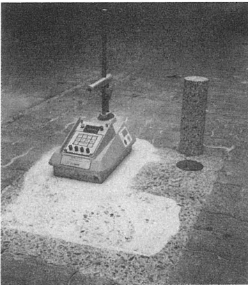
Bild 72: Untersuchungen mit dem radiometrischen Verfahren an einem Betonblock (Ansicht und Lageskizze)
