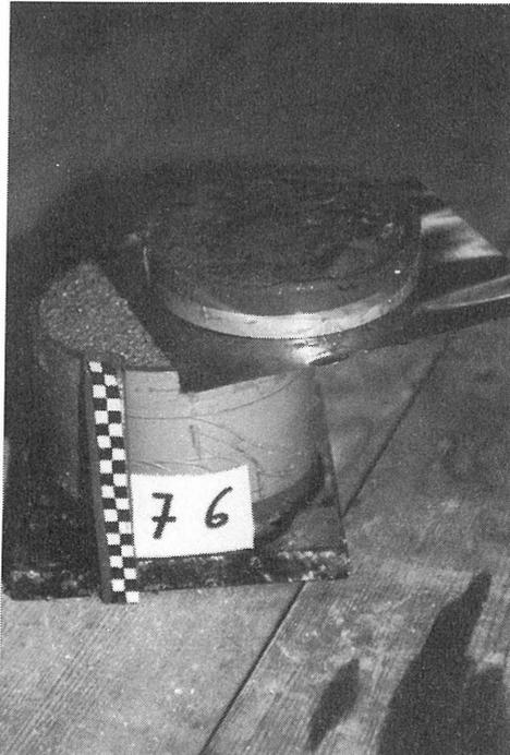
Bild 111: Zerschneiden des mit einem Ausstechzylinder gewonnenen Probekörpers
