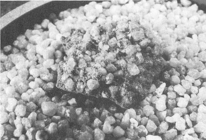
**Bild 113:** Bodenkörper aus dem Bereich der Eindringtiefe. Der blau eingefärbte, ausgefilterte Sand lagert sich an die Körner des Bodens 4 an.
