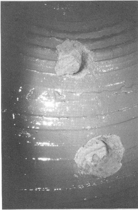
Bild 98: Ortsbrust nach der Entnahme von zwei Proben mit dem Ausstechzylinder
