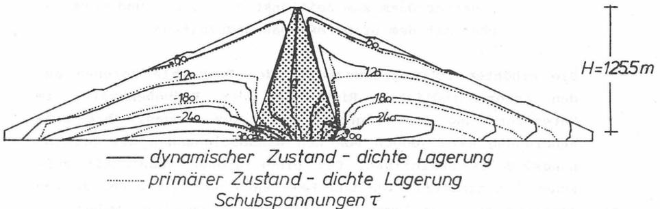
Bild 87: Verteilung der Schubspannungen bei dem dicht gelagerten Damm zum Zeitpunkt  $t = 2,26\text{ s}$  verglichen mit dem primären Spannungszustand
