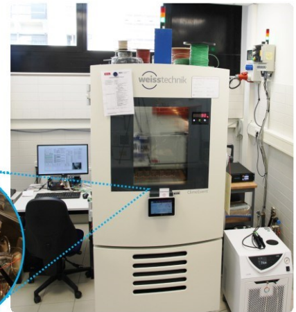
Konfiguration dv/dt Generator zur Kriechstreckenevaluation
