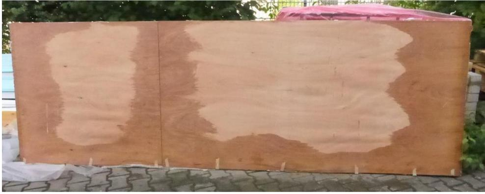
Abbildung 129: infundierte Platte mit trockenen Stellen 3,1 x 1,1 Meter (unten)
