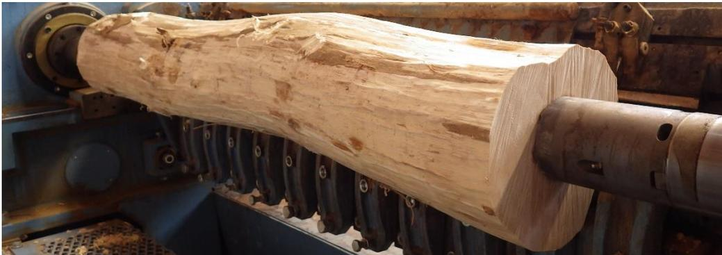
Abbildung 1: Eingespannter Hainbuchenstamm vor dem Schalen.
