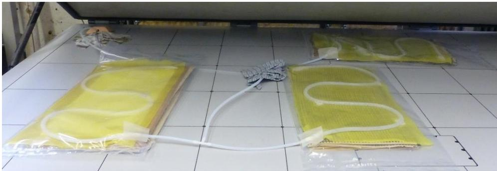
Abbildung 99: Aufbau zum Trocknen der Furnierpakete im Vakuum und anschließender Vakuuminfusion im selben Aufbau.
