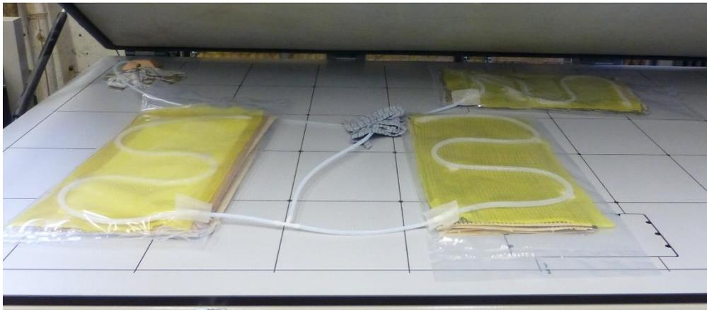
Abbildung 8: Aufbau zum Trocknen der Furnierpakete im Vakuum.
