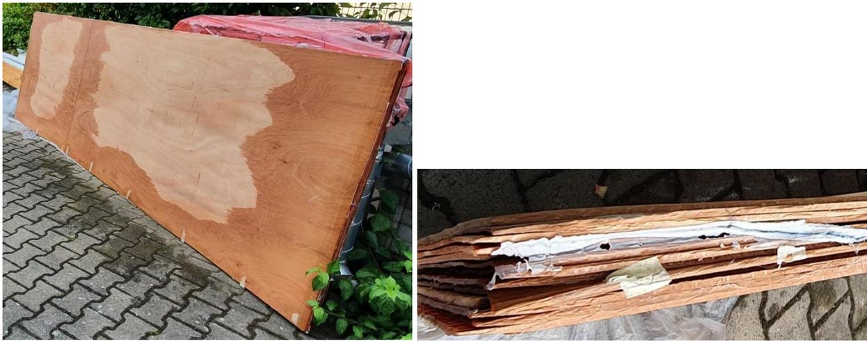
Abbildung 29: Foto des ersten hergestellten Schotts (links) und der schlechten Verklebung (rechts).
