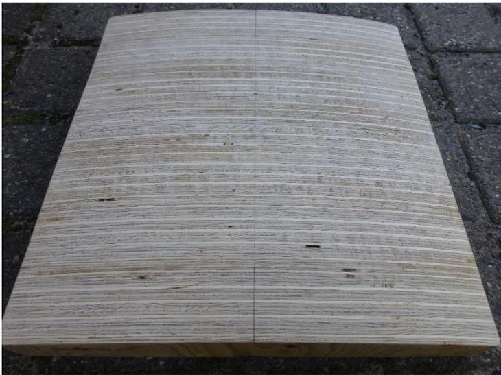
Abbildung 81: Aus massivem Sperrholz hergestellt Positiv-Form für die Herstellung der Fahrbahn aus dünnen Furnierschichten.
