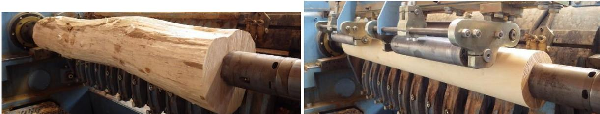
Abbildung 98: Eingespannter Hainbuchenstamm vor dem Schälen (links) und verbliebener Rest des Hainbuchenstamms (rechts) nach dem Schälen.
