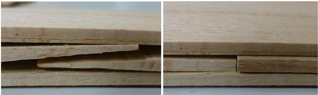
Abbildung 32: Pollmeier Buchenfurniere mit Schäftung in der Mittellage (links) und mit stumpf aneinander gefügten Furnieren in der Mittellage (rechts).
