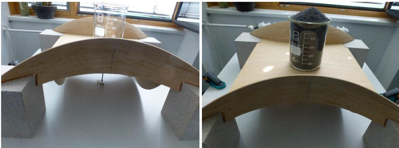
Abbildung 110: Foto der skalierten Brückenkonstruktion mit Messfühler unter dem mittleren Schott (links) und nach abgeschlossener Belastung (rechts).
