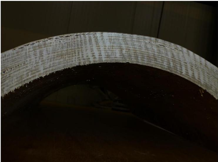
Abbildung 103: Thermographischer Aufbau (links) mit Infrarot Kamera, Rechner und Förderband auf dem das Hainbuchen-Vorhängeschale liegt und Detailaufnahme (rechts) der dünnen mit Epoxidharz verklebten Furniere.
