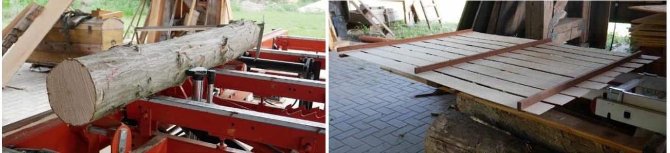
Abbildung 4: Hainbuchenstamm auf dem Sägebett (links) und während der Freilufttrocknung der 2mm dicken Furniere (rechts).
