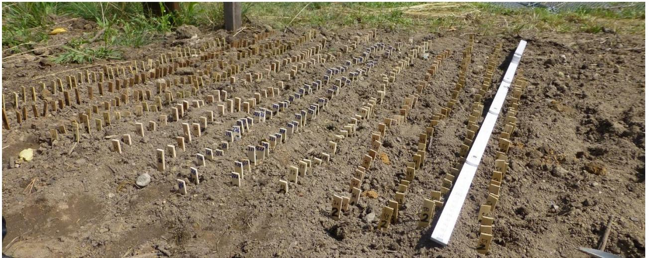
Abbildung 44: Fotos der Holzurniere zu Beginn des Tests. Die Furnierstreifen wurden zur Hälfte in einen humusreichen Boden gesteckt und regelmäßig Proben entnommen und ausgewertet.
