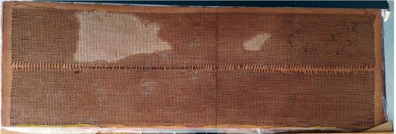
Abbildung 131: infundierte Platte mit trockenen Stellen auf der Unterseite
