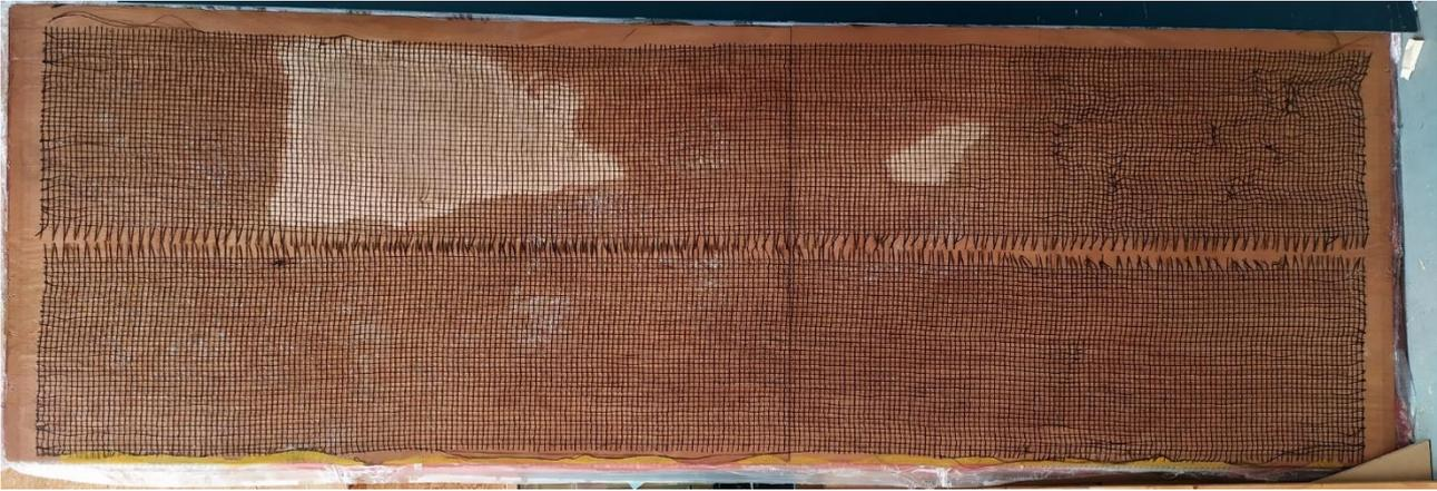
Abbildung 89: Infusionierte Platte mit trockenen Stellen auf der Unterseite.
