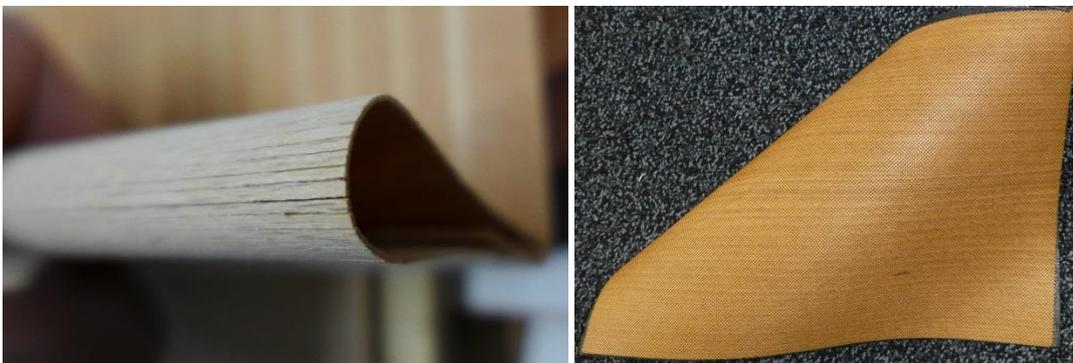
Abbildung 7: Mit längs-geschlitzten 3D-Furnieren (links) und in zwei Richtungen geschlitzten NUO – Holztextilien (rechts) wurden verschiedene Versuche unternommen, auch kleine Biegeradien in unterschiedlichen Richtungen herzustellen.
