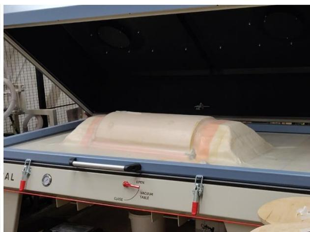
Abbildung 15: Flacher Aufbau bei Vakuuminfusion Form
