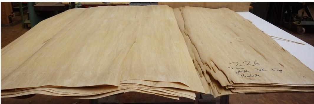
Abbildung 3: 1 mm dicke (links) und 2 mm dicke Furniere (rechts) des Hainbuchenstamms.
