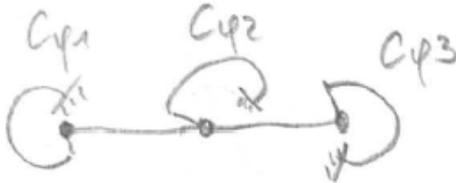
Abbildung 64: Reihenschaltung der Anschlussfedern im Anschlussbereich Querschott / Brüstung
