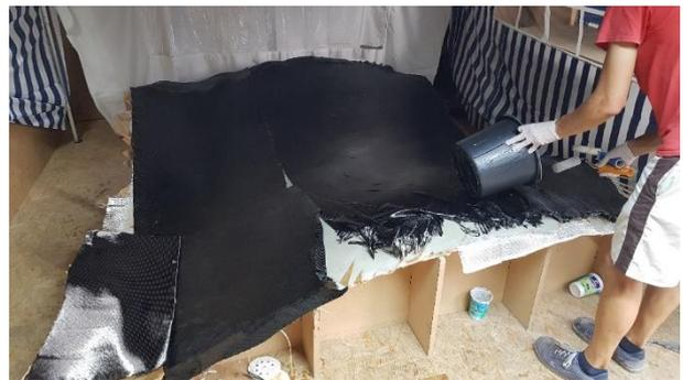
Abbildung 127: bauliche Umsetzung des Werkzeuges für die Vorhangschale – CAD Modell Spantenanordnung; Konturgebundene Harzfaserstreifen; mit Spachtelmasse versiegelte und geschliffene Oberfläche; Versteifung der Schale durch Überlaminieren mit Verstärkungsfasern aus Glas und Carbon (von links oben nach rechts unten)
