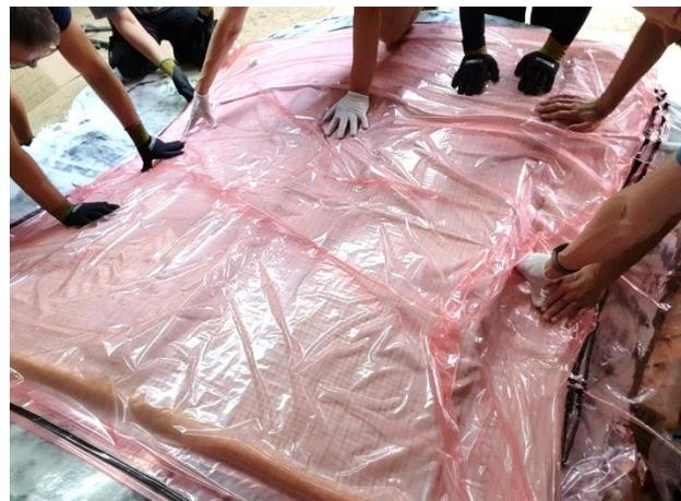
Abbildung 90: In Streifen geschnittenen Furniere werden übereinander gestapelt und in den Zwischenschichten mit Basaltgewebe versehen (links); 6 Arbeiter versuchen die Furniere auf das Formwerkzeug zu drücken um einen Unterdruck zu erzeugen (rechts).
