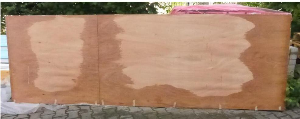
Abbildung 87: Infundierte Platte mit trockenem, hellen Stellen 3,1 m x 1,1 m.
