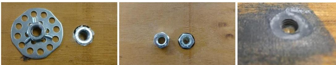
Abbildung 23: Fotos der unterschiedlich verklebten Gewinde. Ein für Fasermaterial hergestelltes Gewinde (links), eine Standardmutter die in ein Sackloch mit Epoxidharz eingeklebt wurde (Mitte) und ein metallisches Zweikomponentensystem<sup>1</sup> in das ein Gewinde eingeschnitten wurde (rechts).
