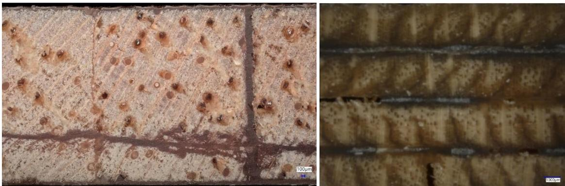
Abbildung 28: Balsaholz in dessen Lumen, Risse und Sägeschnitte das Harz Greenepoxy eingedrungen ist (links) und Schälurniere eines Hainbuchenfurniers dessen Schälrisse mit Epoxidharz ausgefüllt sind (rechts). Die Fugen zwischen den einzelnen Furnieren sind dagegen nicht vollständig gefüllt (weiße Stellen).
