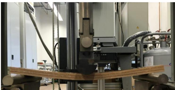
Abbildung 33: Maschine zum Testen der Biegefestigkeit bei geschäfteten bzw. stumpfen Verklebungen in der Mittellage von dreischichtigen Furnieren.
