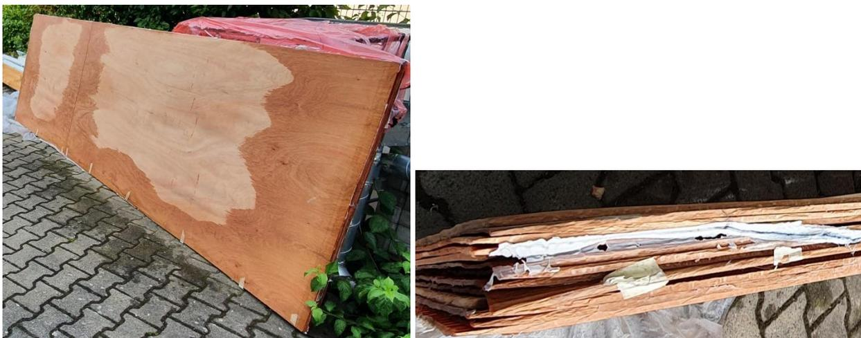
Abbildung 102: Foto des ersten hergestellten Schotts (links) und der schlechten Verklebung (rechts).
