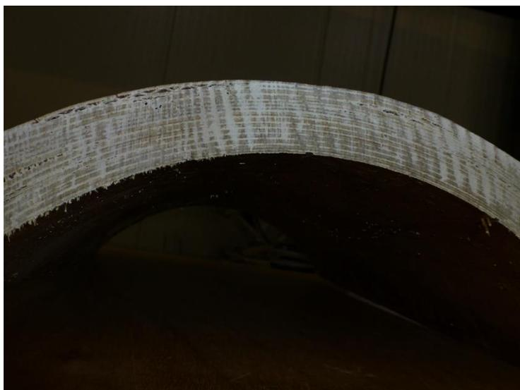
Abbildung 35: Thermographischer Aufbau (links) mit Infrarot Kamera, Rechner und Förderband auf dem das Hainbuchen-Vorhängeschale liegt und Detailaufnahme (rechts) der dünnen mit Epoxidharz verklebten Furniere.
