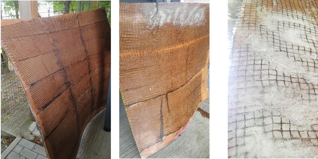
Abbildung 91: Infundierte Vorhangschale mit Wellen auf der Oberseite; Unterseite mit Falten in den Basaltfasern und schaumigen Stellen; Nahaufnahme der schaumigen Stellen (von links nach rechts).
