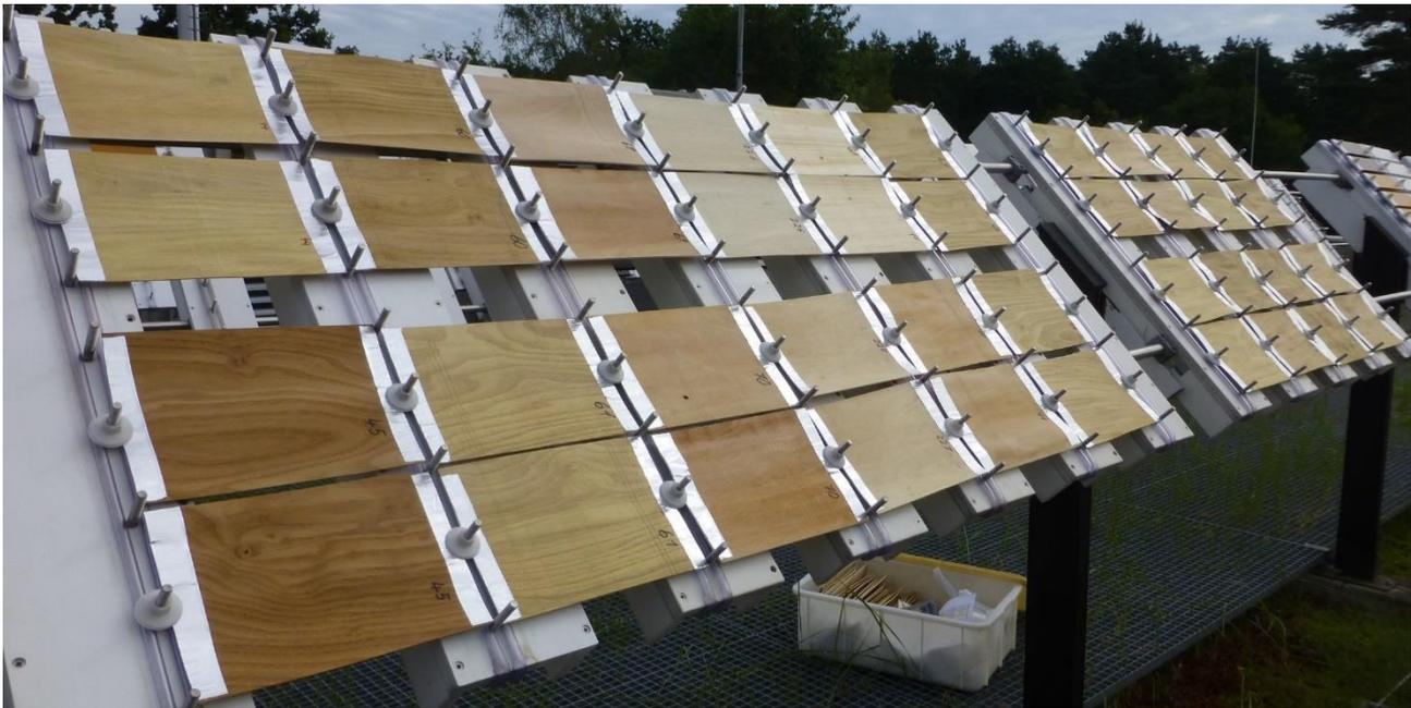
Abbildung 42: Foto der Furniere in der Außenbewitterung zu Beginn des Tests am 27.7.2020.
