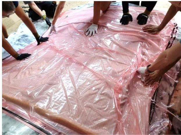
Abbildung 132: in Streifen geschnittenen Furniere werden übereinander gestapelt und in den Zwischenschichten mit Basaltgewebe versehen (links); 6 Arbeiter versuchen die Furniere auf das Formwerkzeug zu drücken um einen Unterdruck zu erzeugen (rechts)
