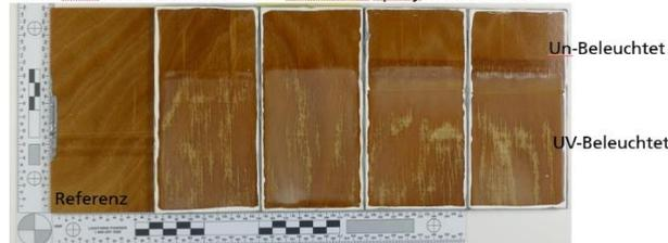
Abbildung 48: Fotos der Sperrholzproben bei denen während der Herstellung in Vakuuminfusion bereits das UV Schutzmittel in das Epoxidharz mit 3% (links) bzw. 1% (rechts) eingerührt worden sind.
