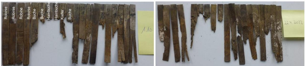
Abbildung 45: Fotos der in Bodenkontakt befindlichen Furniere nach 6 Monaten (links) und 12 Monaten (rechts). Deutlich sind die Spuren des Holzabbaus zu erkennen.
