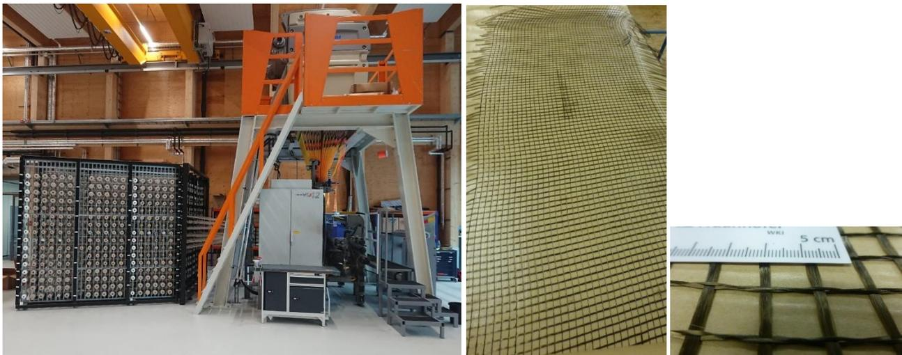
Abbildung 26: Webmaschine (links) für 50 cm breites Basaltfasergewebe (Mitte) das mit Basaltfaser ohne Schlichte als Drehergewebe (rechts) hergestellt wurde.
