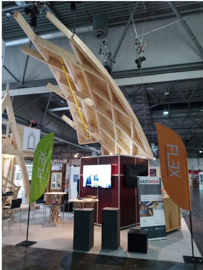
Abbildung 2: Segmentschalen nach dem Prinzip ReFlexRoof (TimberPlan+) auf der Denkmal-Messe 2022 in Leipzig, Grafik: FLEX @ HTWK Leipzig, Marius Zwigart, M.A. | Architekt
