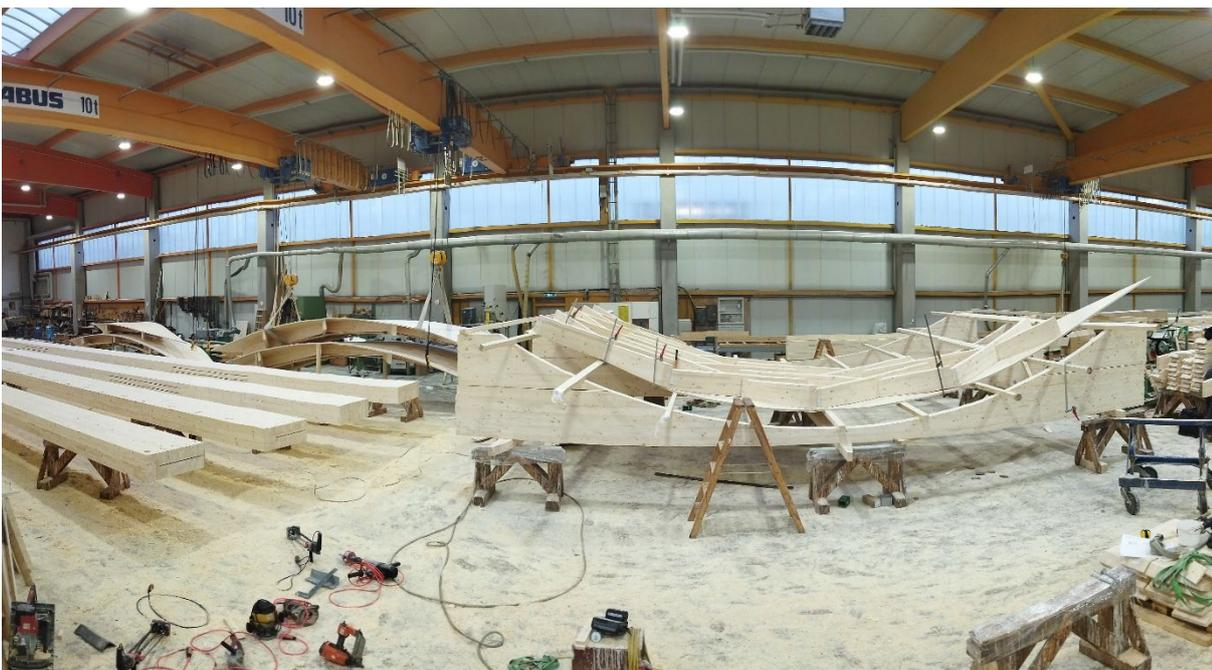
Abbildung 41: Fertigung der Halbschalenelemente des Demonstrators in der Werkhalle der Fa. STRAB, Grafik @ FLEX, Marius Zwigart, M.A. | Architekt
