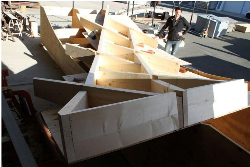
Abbildung 44: Fertigung der Halbschalenelemente des Demonstrators mit Bauteilen der Fa. STRAB,
