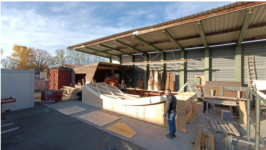
Abbildung 45: Fertigung von zwei Halbschalen nach dem Prinzip ReFlexRoof (TimberPlan+)
