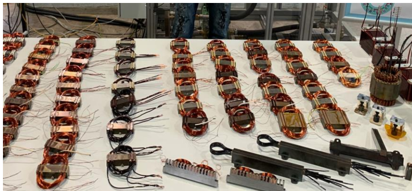
Prüflingsvarianten für die elektrische Alterung bei definierter Temperatur
