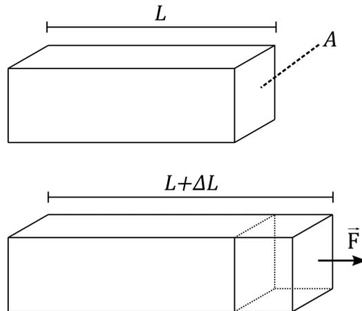
Abbildung 2: Skizze des Dehnungsprozesses eines Drahtes der Länge  $L$  und der Querschnittsfläche  $A$  auf die Länge  $L + \Delta L$  durch das Anlegen einer Zugkraft  $\vec{F}$
