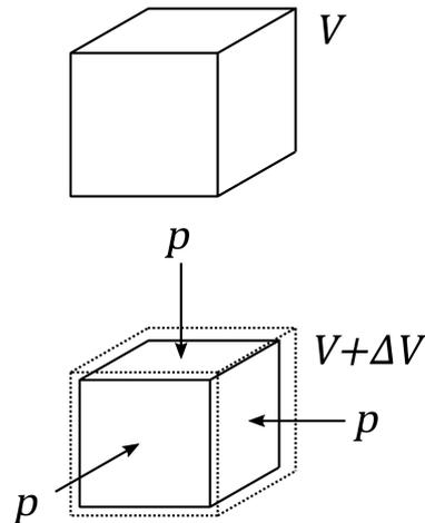
Abbildung 4: Skizze des Kompressionsprozesses eines Würfels des Volumens  $V$  um  $\Delta V < 0$  durch gleichmäßiges Anlegen eines Druckes  $p$  auf alle Seitenflächen.
