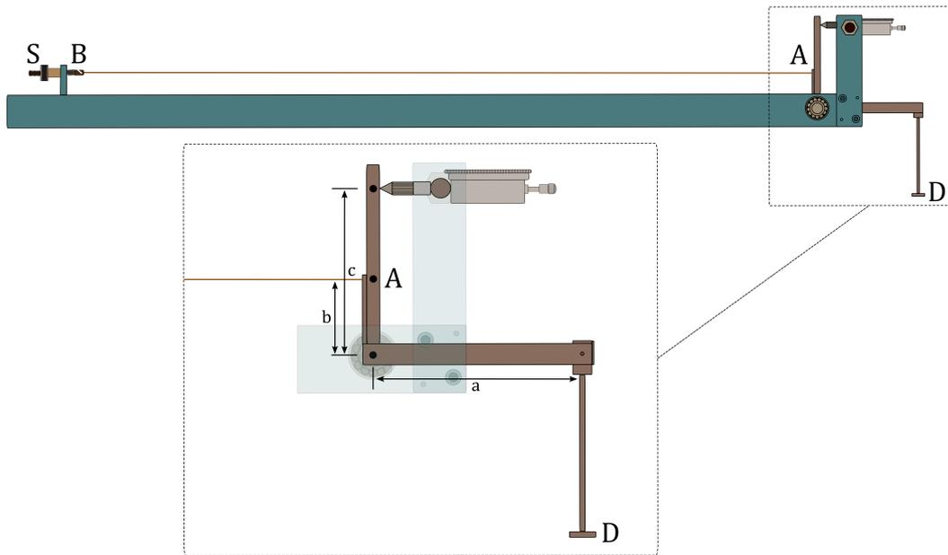
Abbildung 7: Schema des Versuchsaufbaus zur Dehnungsmessung. Vergrößert eingezeichnet sind die unterschiedlichen Hebel, die für einen Kraftübertrag auf die Messuhr führen. Mehr Informationen finden sich im Fließtext.
