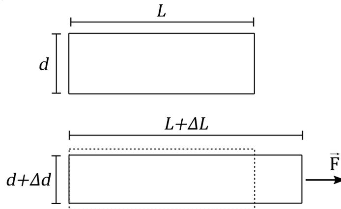
Abbildung 3: Skizze des Querkontraktionsprozesses bei Dehnung eines Drahtes der Länge  $L$  auf die Länge  $L + \Delta L$  durch das Anlegen einer Zugkraft  $\vec{F}$
