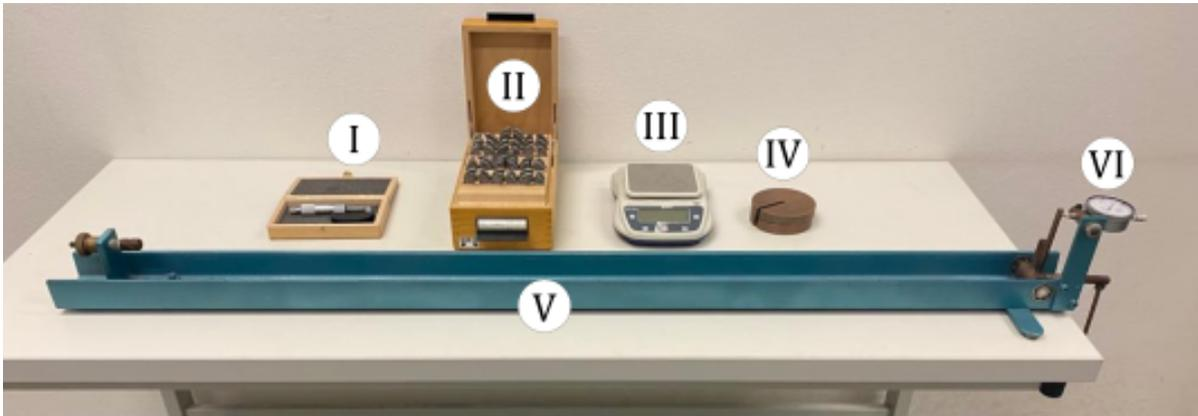
Abbildung 6: Versuchsaufbau zur Messung des Elastizitätsmoduls  $E$  von Drähten mit Beschriftung der wesentlichen Komponenten: (I) Mikrometerschraube zur Messung des Drahtdurchmessers, (II) Box mit Schlitzgewichten aus Blei, (III) Digitalwaage, (IV) Messinggewichte ( $m = 1 \text{ kg}$ ) zur Vorbelastung der Drähte, (V) Vorrichtung zur Dehnungsmessung (Details in Abb. 7), (VI) Messuhr zur Messung der Längenänderung
