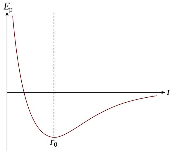
Abbildung 1: Schema des abstandsabhängigen Wechselwirkungspotentials zweier Atome mit eingezeichneter Gleichgewichtslage  $r_0$ .
