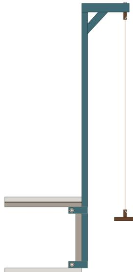
Abbildung 8: Schematischer Aufbau des Torsionspendels.
