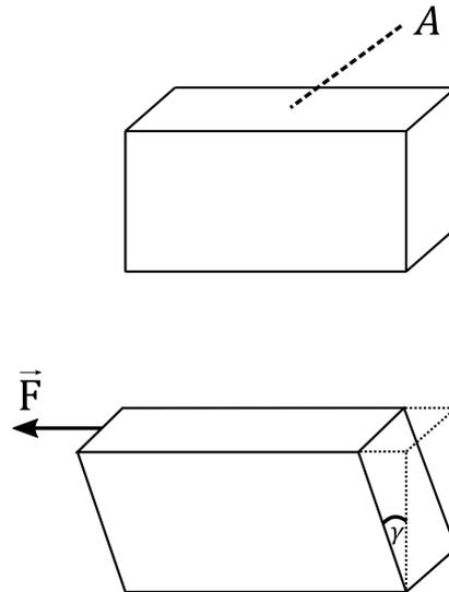
Abbildung 5: Skizze des Scherungsprozesses eines quaderförmigen Körpers, bei der eine an der Deckfläche  $A$  tangential angreifende Kraft  $\vec{F}$  zur relativen Verschiebung der oberen und unteren Deckfläche um den Scherwinkel  $\gamma$  führt.
