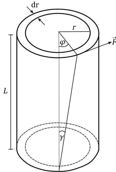
Abbildung 9: Skizze zur Berechnung des Torsionsmodul  $G$  aus Drahtschwingungen.
