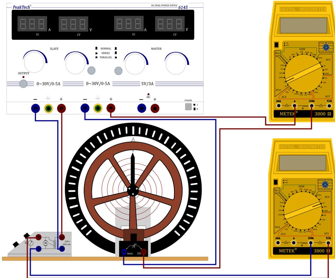
Abbildung 3: Schaltskizze für die Messungen mit dem Pohlschen Pendel
