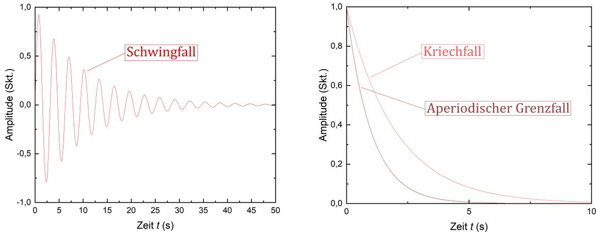
Abbildung 1: Modellhafte Veranschaulichung des Schwingfalls, Kriechfalls und aperiodischen Grenzfalls
