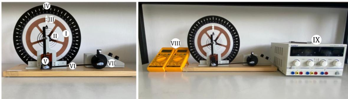
Abbildung 2: Versuchsaufbau mit Beschriftung der wesentlichen Komponenten: (I) Metallscheibe, (II) Spiralfeder, (III) Kunststoffzeiger, (IV) Skala (Einheit Skt.), (V) Wirbelstrombremse, (VI) starre Verbindung zum Motor, (VII) Motor mit regelbarer Geschwindigkeit, (VIII) Multimeter, (IX) Strom-/Spannungsquelle.
