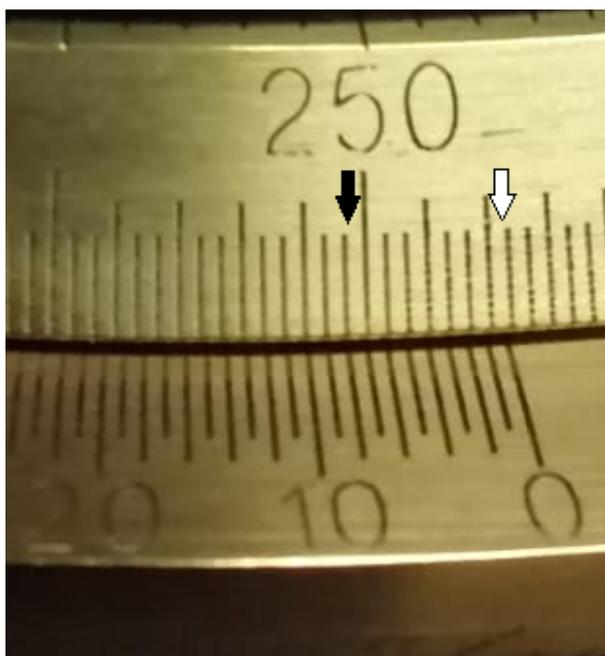
Abb. 3: Beispiel zum korrekten Ablesen des Nonius
