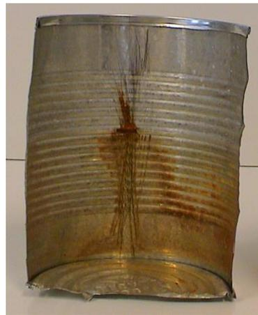
**Abb.2: Korrosion einer Weißblechdose.**
