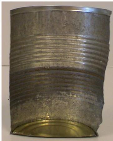
**Abb.1: Korrosion einer Weißblechdose.**
