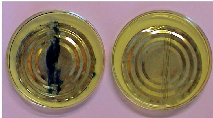
Abb. 3: Korrosion zweier Weißblechdosendeckel und Nachweis der entstehenden  $\text{Fe}^{2+}$ -Ionen.
