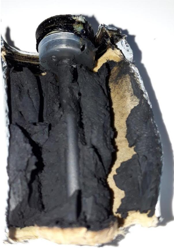
Nun wird der Zinkbecher geöffnet und man erkennt eine Kunststoffisolierung, die den Kohlestift vom Zinkmantel trennt. Der Kohlestift ist von einer schwarzen Masse, dem Elektrolyten, umgeben. Sie besteht aus Braunstein ( $\text{MnO}_2$ ), Kohlenstoff und Ammoniumchlorid ( $\text{NH}_4\text{Cl}$ ). Die Masse wird durch eine dünne Pappe vom Zinkbecher getrennt.
