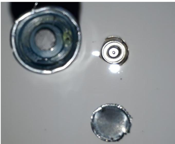
Der Boden des Zinkbeckers wird abgeschnitten und die Metallkappe des Pluspols entfernt. Am Pluspol erkennt man einen Kohlestift, der aus dem Becher ragt und elektrisch mit der Metallkappe verbunden ist.
