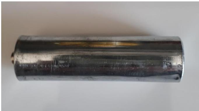
Entfernt man den Kunststoffmantel, kommt ein Zinkbecher mit aufgesetztem Pluspol zum Vorschein. Der Becher selbst stellt den Minuspol der Batterie dar und liefert die Elektronen (Oxidation).
