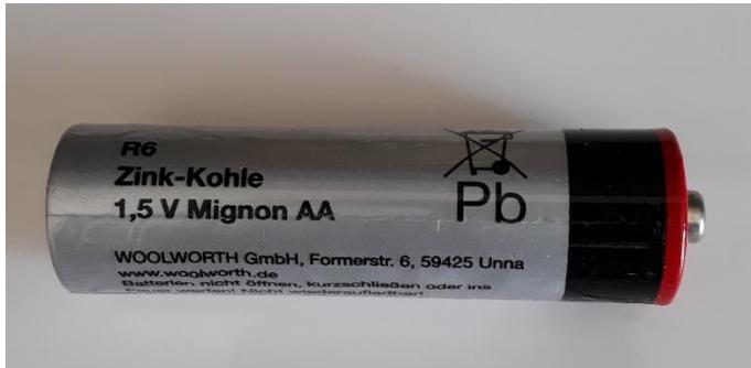
Die hier abgebildete Zink-Kohle-Batterie wird in mehreren Schritten in ihre Einzelbestandteile zerlegt, um den Aufbau zu verdeutlichen.
