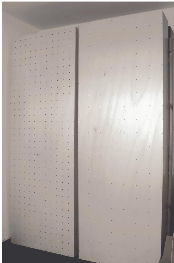
**Abbildung 12: Selbstgebaute Lochplattenabsorber**
