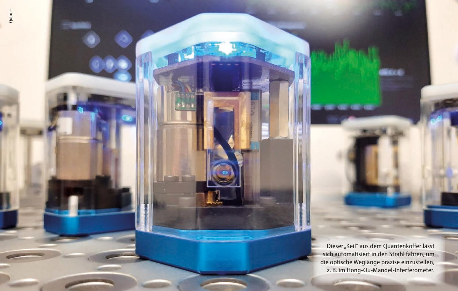
Dieser „Keil“ aus dem Quantenkoffer lässt sich automatisch in den Strahl fahren, um die optische Weglänge präzise einzustellen, z. B. im Hong-Ou-Mandel-Interferometer.
