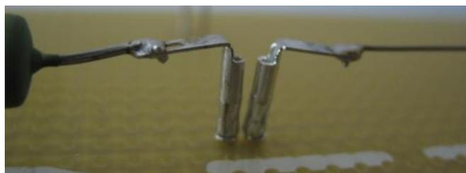
*Abb. 12: Steckverbindungen auf der Rasterplatte*
