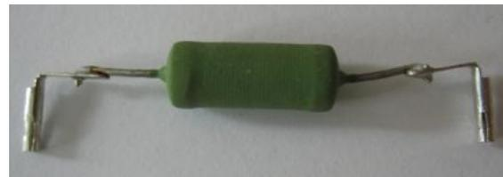
*Abb. 11: Steckverbindungen mit Steckschuhen*
