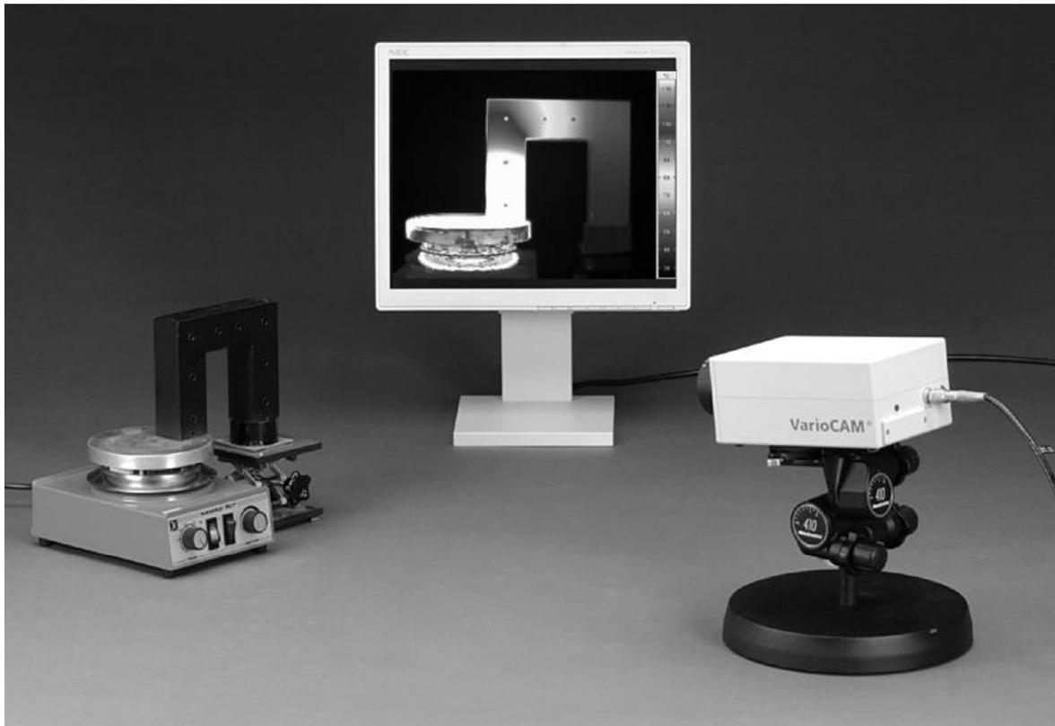
Abb. 2: Wärmeleitung durch Metall (aus [3]). (Das Wärmebild wurde aus einem Farbbild mit Regenbogenskala gewonnen und zeigt daher in der Graustufendarstellung keine eindeutige Skala. Das Originalbild ist über die Experimentdatenbank DOPPLER [4] verfügbar.)
