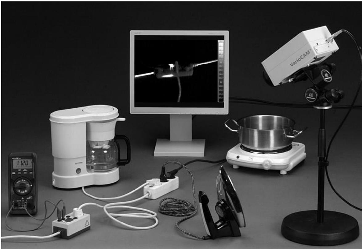
Abb. 3: Parallelschaltung von Elektrogeräten (aus [3]).
