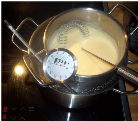
Abbildung 8: Messaufbau zur Bestimmung der Weincremeerwärmung im Wasserbad
