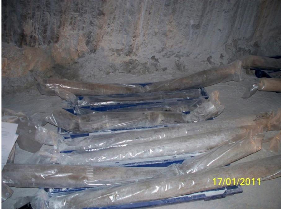
Abb. 3.2-2: Kerne aus Staßfurt-Steinsalz Na<sub>2</sub>SP im ehemaligen BGR-Versuchsfeld der 800-m-Sohle.
