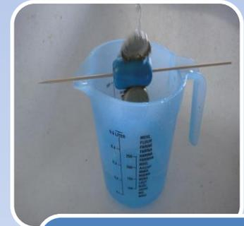
Leg das Wasserrad quer über einen Becher. Lass einen Wasserstrahl darüber laufen!
