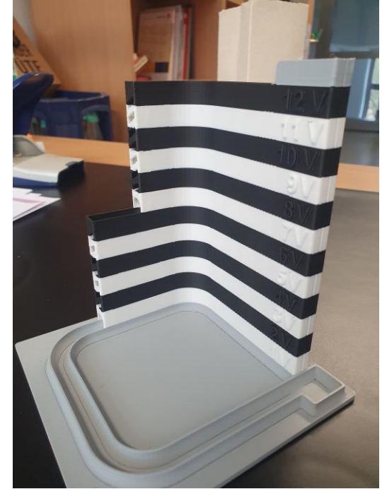
Windkanal und Potentialmodell aus dem 3D-Drucker
