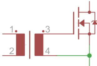
Im Rahmen dieser Arbeit soll untersucht werden, in wie weit eine Ansteuerung der modernen Halbleitern mit besonders einfachen Konzepten möglich ist. Zu nennen wäre hier z.B. eine direkte Ansteuerung mit Impulstransformatoren.
