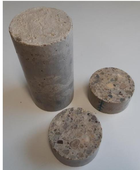
Zylindrische Betonproben des IBMB. Die kleinen Proben (Höhe: 5 cm, Durchmesser: 10 cm) werden für Chloridmigrationsversuche verwendet.
