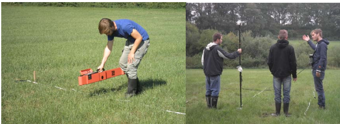
Abbildung 1: Fotos von Geländemessungen mit Elektromagnetik (links) und Magnetik (rechts).
