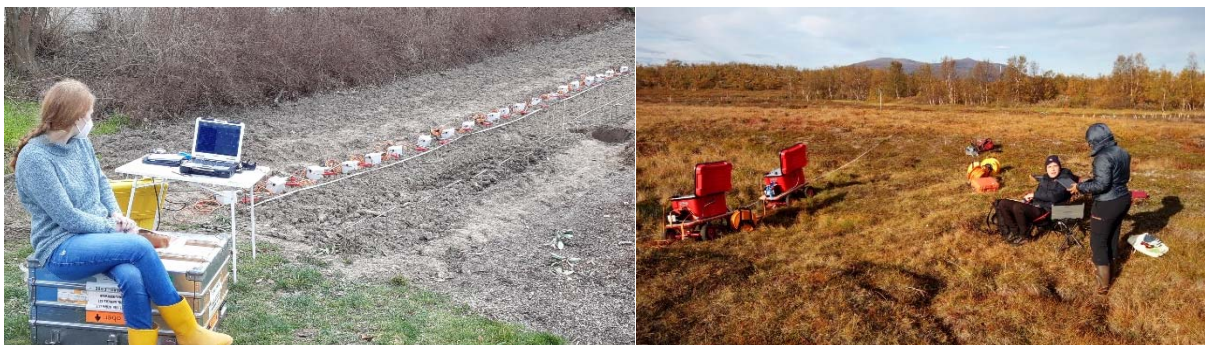
Abbildung: Links: Messung mit der Multikanalapparatur SIP256C auf einem Testfeld. Rechts: Messung mit der Chameleon II auf einem Permafrostgebiet.
