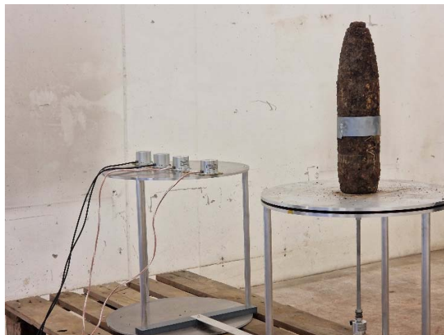
Abbildung: Magnetische Vermessung eines Sprenggranatenblindgängers. Auf der linken Platte die 4 verwendeten Sensoren, rechts der entschärfte Blindgänger.
