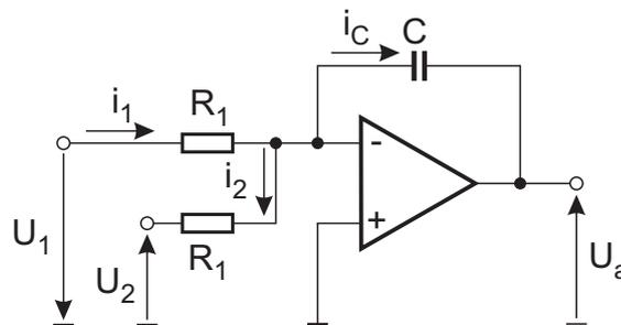
Bild 9.22: Operationsverstärkerschaltung eines I-Reglers
