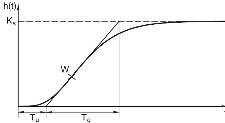
Bild 9.58: Übergangsfunktion, Einstellregeln nach Ziegler/Nichols
