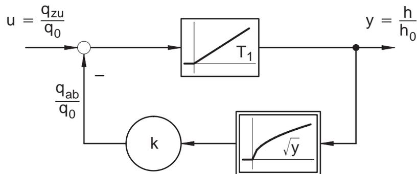
Bild 3.3: Normiertes Blockschaltbild des Behälters
