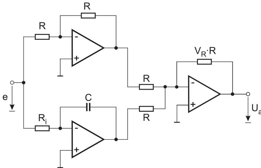
Bild 9.38: Operationsverstärkerschaltung für PI-Regler
