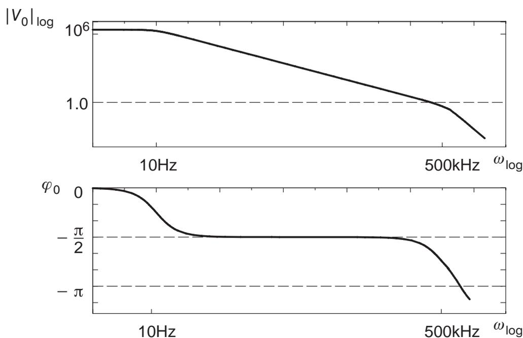
Bild 8.7: Typisches Bode-Diagramm eines Operationsverstärkers
