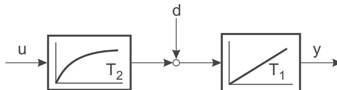
Bild 9.40: Drehzahlregelstrecke
