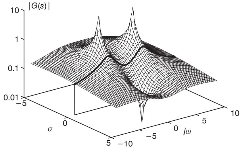
Bild 4.2: Dreidimensionale Darstellung des Betrages der Übertragungsfunktion  $|G(s)|$
