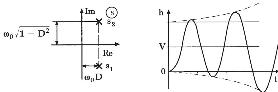
Bild 5.37: Pollage und Sprungantwort eines Systems zweiter Ordnung mit  $-1 < D < 0$
