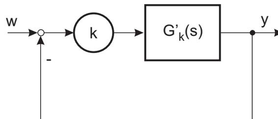
Bild 10.5: Pollage in Abhängigkeit der Gesamtverstärkung  $k$
