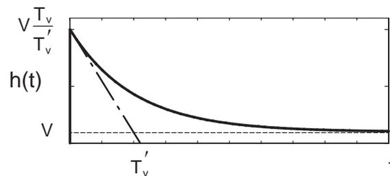
Bild 9.11: Sprungantwort PD(T)-Regler
