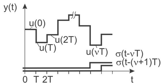
Bild 13.7: Beschreibung dieser Stufenfunktion durch Sprungfunktionen
