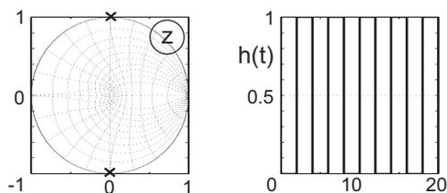
Bild 18.3: Alternierender Einschwingvorgang mit halber Abtastzeit
