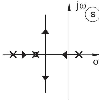
Bild 10.15: Kompensation durch einen Vorhalt
