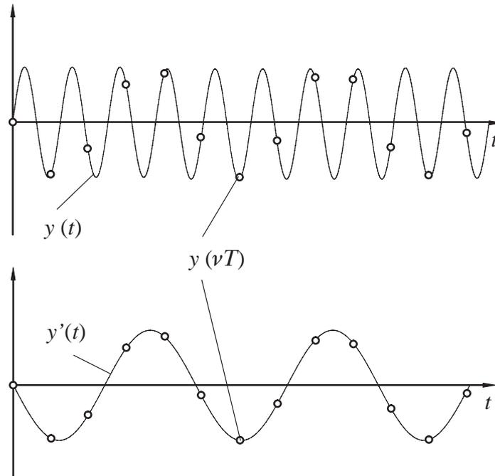
Bild 18.4: Abtasttheorem
