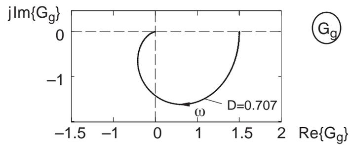
Bild 9.28: Ortskurve von  $G_g(j\omega)$
