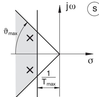
Bild 10.4: Minimale Winkel für die relative Dämpfung
