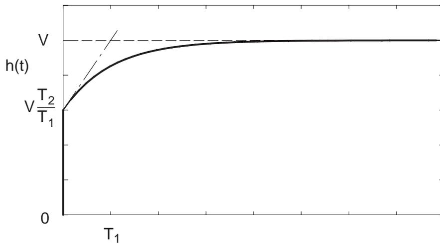
Bild 5.21: Sprungantwort eines PTD-Gliedes ( $T_1 > T_2 > 0$ )
