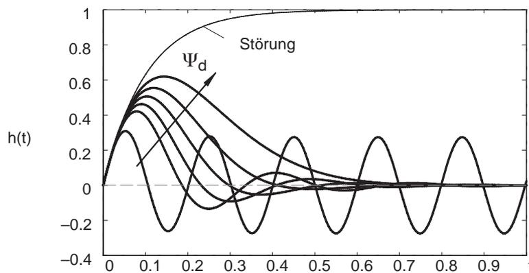
Bild 9.73: Störverhalten mit PID-Regler
