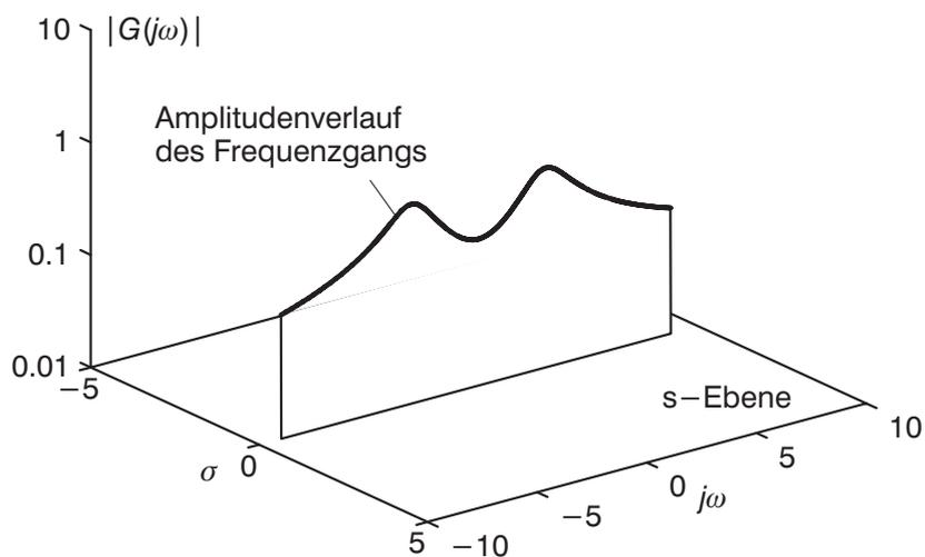
Bild 4.3: Dreidimensionale Darstellung des Amplitudengangs  $|G(j\omega)|$
