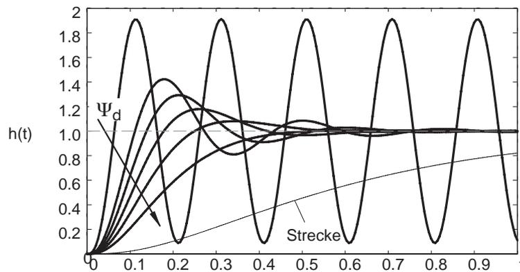
Bild 9.72: Führungsverhalten mit PID-Regler
