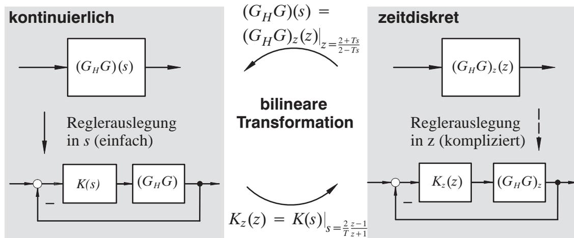
Bild 19.5: Reglerauslegung in  $s$
