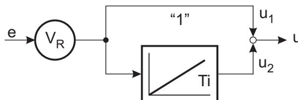
Bild 9.31: PI-Regler in Parallelstruktur
