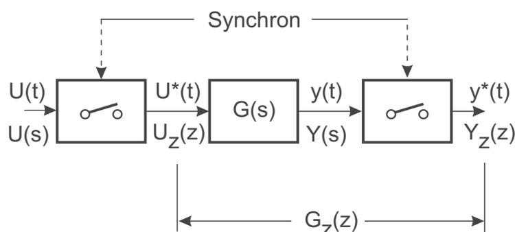
Bild 17.1: Kontinuierliches System zwischen Abtastern
