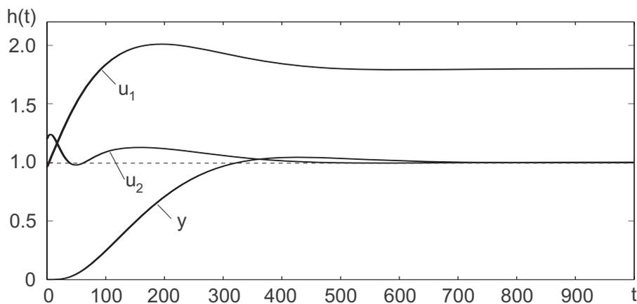
Bild 11.18: Sprungantwort bei Führungssprung
