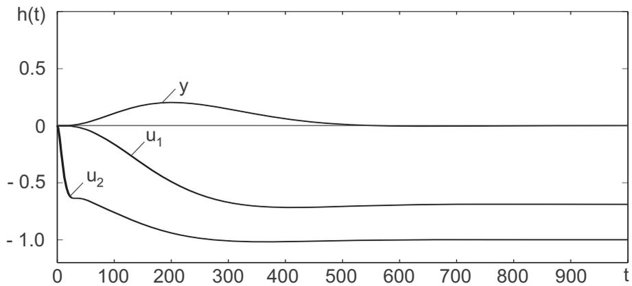
Bild 11.22: Sprungantwort bei Sprung der Störgröße  $d_1$
