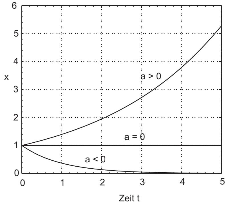
Bild 3.6: Eigenbewegung eines Systems erster Ordnung für  $x_0 = 1$
