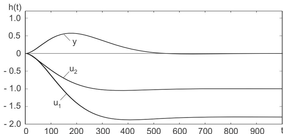
Bild 11.20: Sprungantwort bei Sprung der Störgröße  $d_2$
