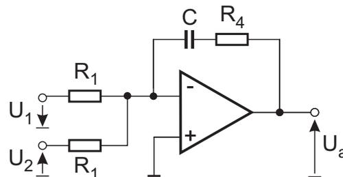
Bild 9.39: Operationsverstärkerschaltung für PI-Regler
