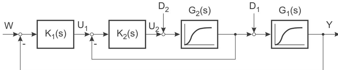
Bild 11.11: Vergleichsstrecke für Kaskadenregelung und einschleifige Regelung
