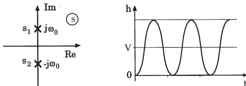
Bild 5.34: Pole und Sprungantwort eines PT<sub>2</sub>-Gliedes mit  $D = 0$
