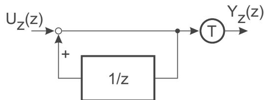
Bild 16.2: Diskreter Integrator nach der Rechteckregel zur Bildung der Obersumme
