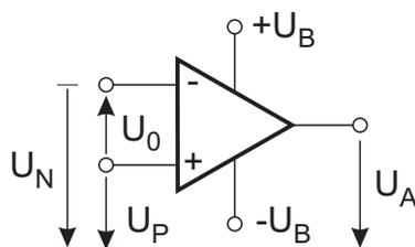
Bild 8.1: Schaltsymbol eines Operationsverstärkers
