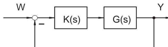
Bild 7.11: Blockschaltbild eines Regelkreises
