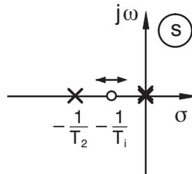
Bild 9.44: Pol-/Nullstellenverteilung für  $T_i > T_2$
