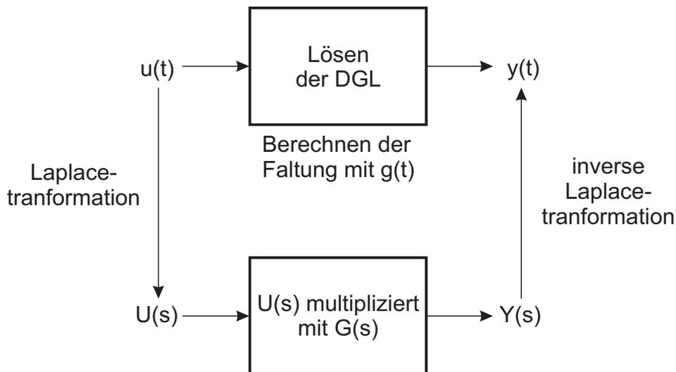
Bild 4.1: Lösen einer Differentialgleichung mit Hilfe der Laplace-Transformation
