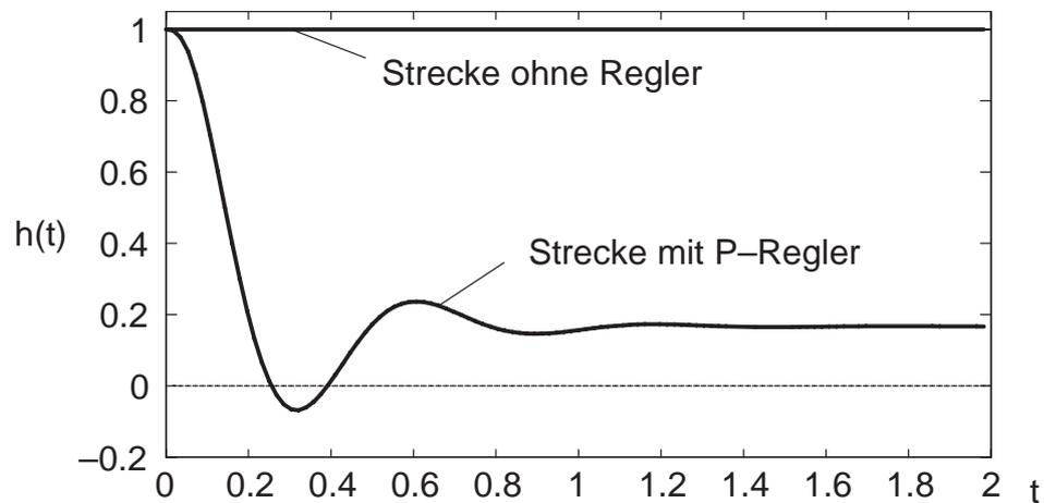
Bild 7.6: Sprungantwort der Störgröße  $d_2 \rightarrow y$
