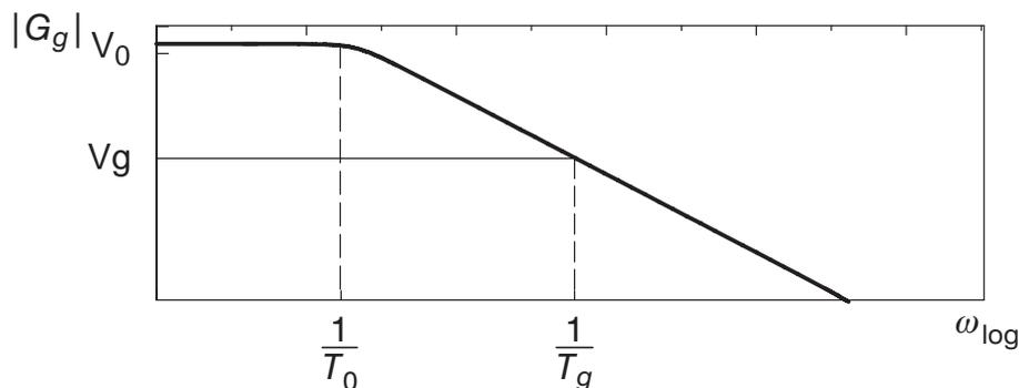
Bild 8.9: Bandbreite eines Operationsverstärkers
