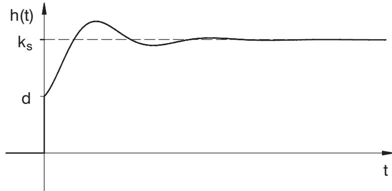
Bild 3.10: Sprungantwort eines Systems zweiter Ordnung mit Durchgriff
