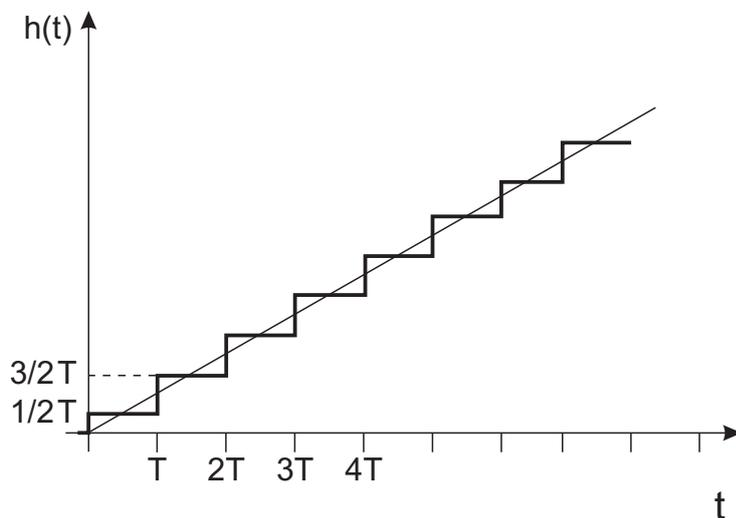
Bild 16.4: Sprungantwort eines diskreten Integrators nach der Trapezregel
