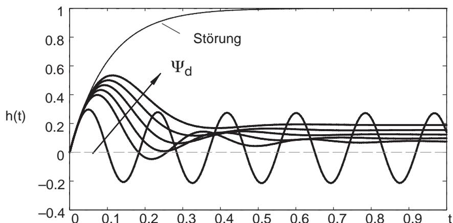
Bild 9.67: Störverhalten mit PD-Regler
