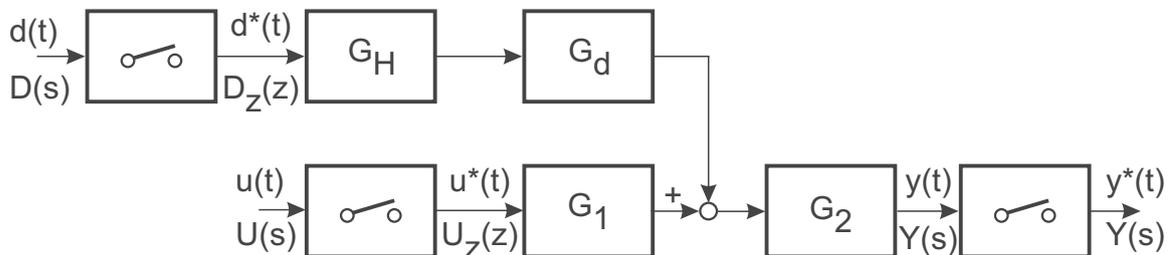
Bild 17.5: Zeitdiskreter Ansatz der Störung
