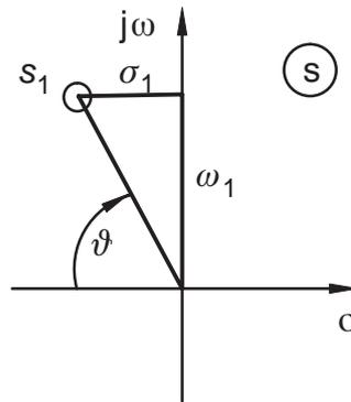
Bild 7.25: Graphischer Zusammenhang von  $s_1$ ,  $\vartheta$  und  $\omega_1$
