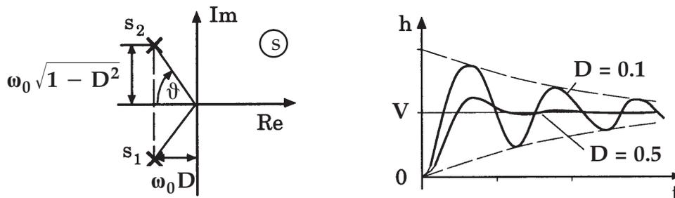
Bild 5.33: Pole und Sprungantwort eines PT<sub>2</sub>-Gliedes mit  $0 < D < 1$
