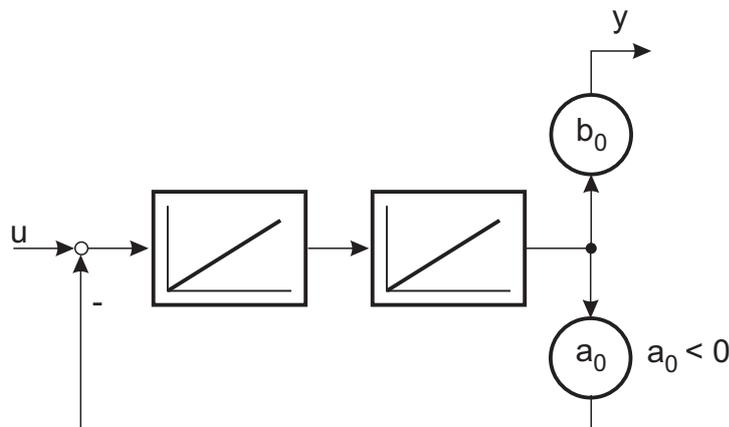
Bild 5.40: Mitgekoppelter doppelter Integrator
