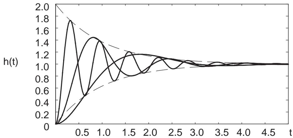
Bild 10.2: Einschwingverhalten bei Polen mit gleichem Realteil
