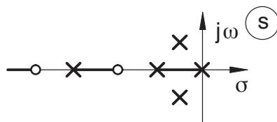
Bild 10.8: Teile der Wurzelortskurve für  $k \geq 0$
