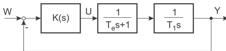
Bild 11.9: Kaskadenstufe mit Integrator
