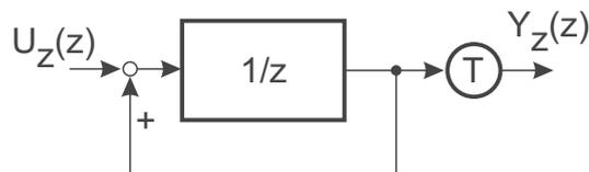
Bild 16.3: Diskreter Integrator nach der Rechteckregel zur Bildung der Untersumme
