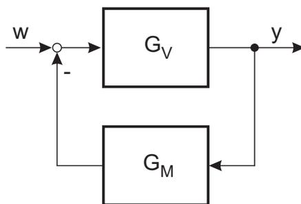
Bild 9.61: Blockschaltbild mit Messglied in der Rückführung
