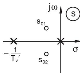
Bild 9.52: PID mit komplexen Nullstellen
