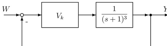
Bild 7.14: Blockschaltbild  $PT_3$ -Strecke mit P-Regler
