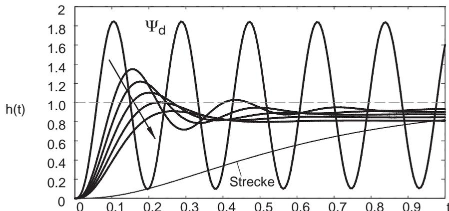
Bild 9.66: Führungsverhalten mit PD-Regler
