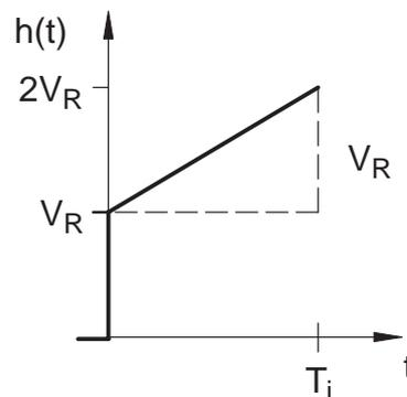
Bild 9.33: Sprungantwort eines PI-Reglers
