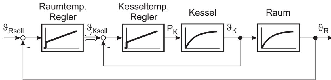
Bild 11.2: Kaskadenregelung der Heizungsanlage
