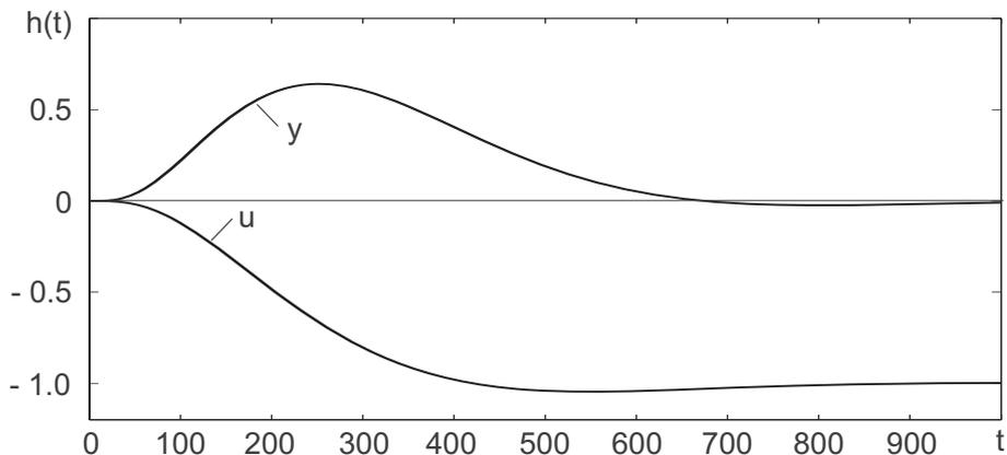
Bild 11.16: Sprungantwort bei Sprung der Störgröße  $d_1$
