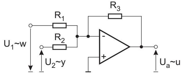
Bild 9.2: Operationsverstärkerschaltung für P-Regler
