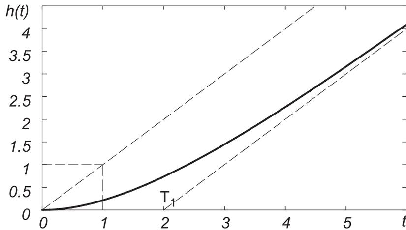
Bild 5.43: Sprungantwort eines  $IT_1$ -Gliedes
