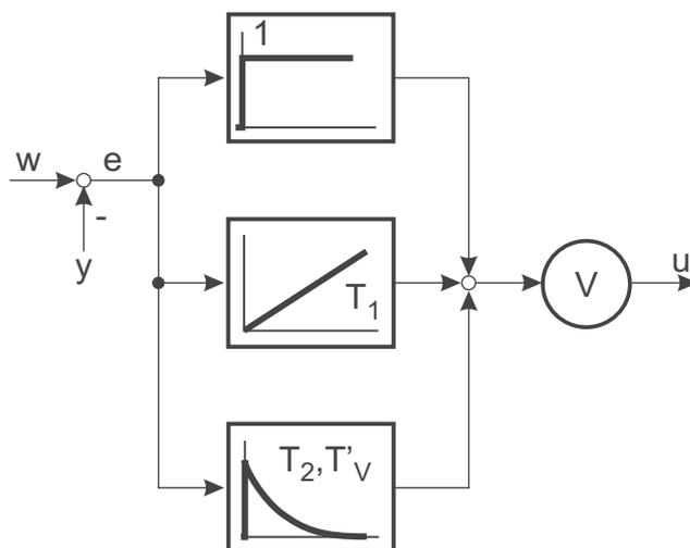
Bild 9.50: PID-Regler in Parallelform
