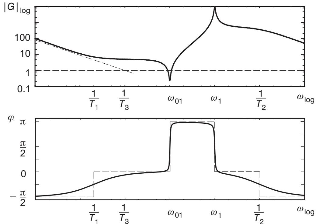
Bild 6.1: Bode-Diagramm für die Übertragungsfunktion (6.9)
