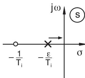
Bild 9.35: Pol-/Nullstellendiagramm eines PTD-Gliedes
