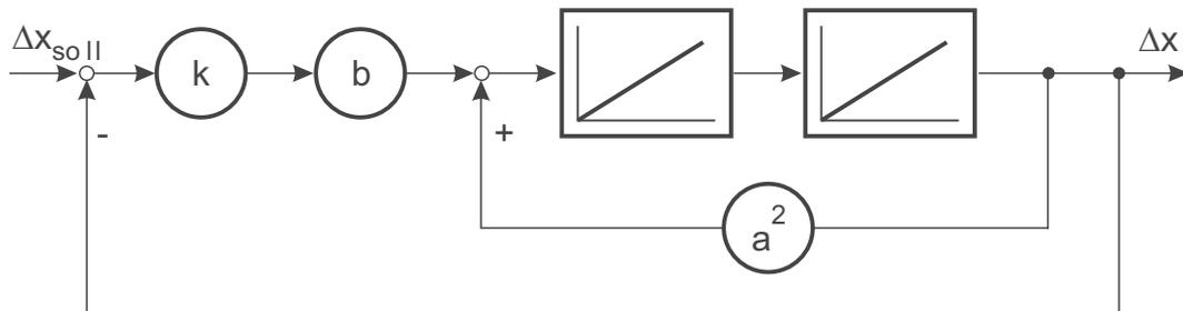
Bild 10.14: Einstellung der Resonanzfrequenz über den Faktor  $k$
