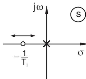
Bild 9.34: Pol-/Nullstellendiagramm PI-Regler
