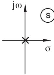
Bild 5.4: Pol eines Integrators
