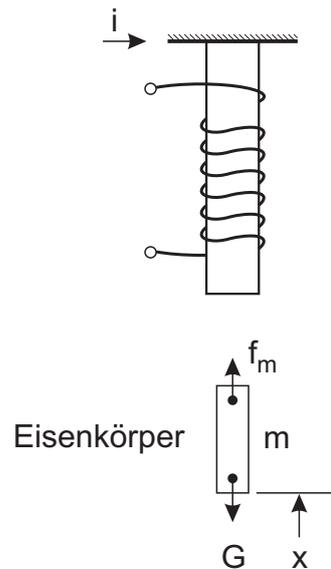
Bild 10.10: Prinzipskizze für Schwebekörper
