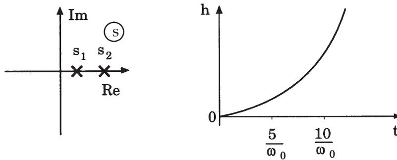
Bild 5.39: Pollage und Sprungantwort eines Systems zweiter Ordnung mit  $D < -1$
