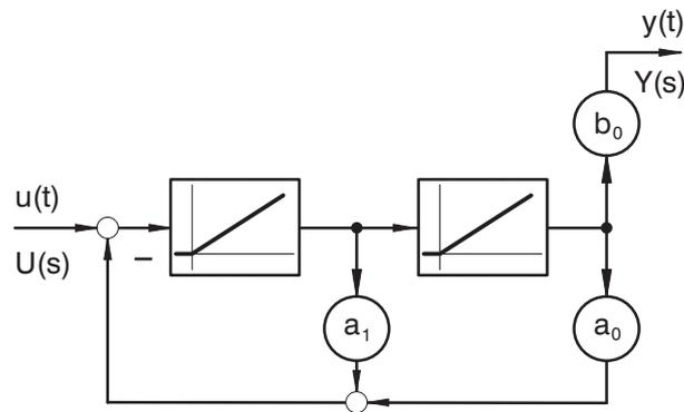
Bild 5.29: Blockschaltbild eines  $PT_2$ -Gliedes in Normalform
