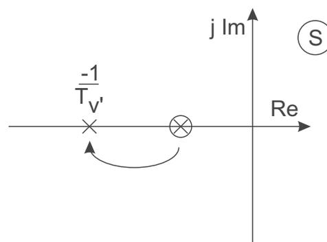
Bild 9.17: Polverschiebung
