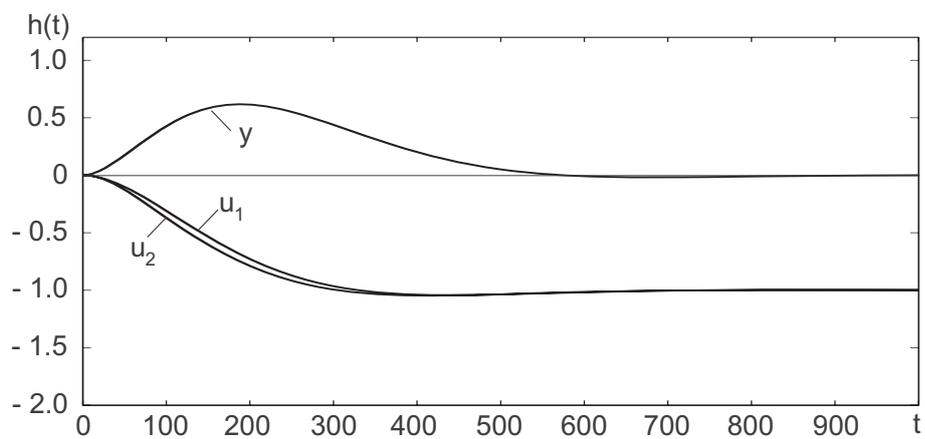
Bild 11.14: Sprungantwort bei Sprung der äußeren Störgröße  $d_1$
