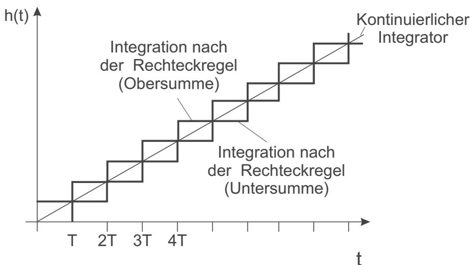
Bild 16.1: Vergleich der Sprungantworten: Kontinuierlicher Integrator, Diskreter Integrator: Unter- und Obersumme
