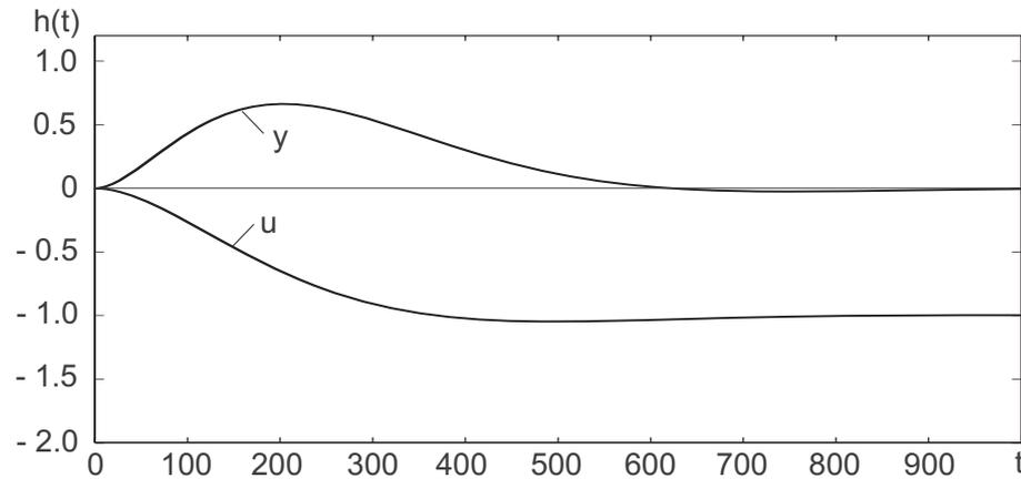
Bild 11.17: Sprungantwort bei Sprung der Störgröße  $d_2$
