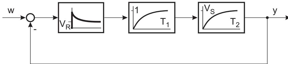
Bild 9.18: Beispiel  $PT_2$ -Strecke (reelle Pole) mit PDT-Regler
