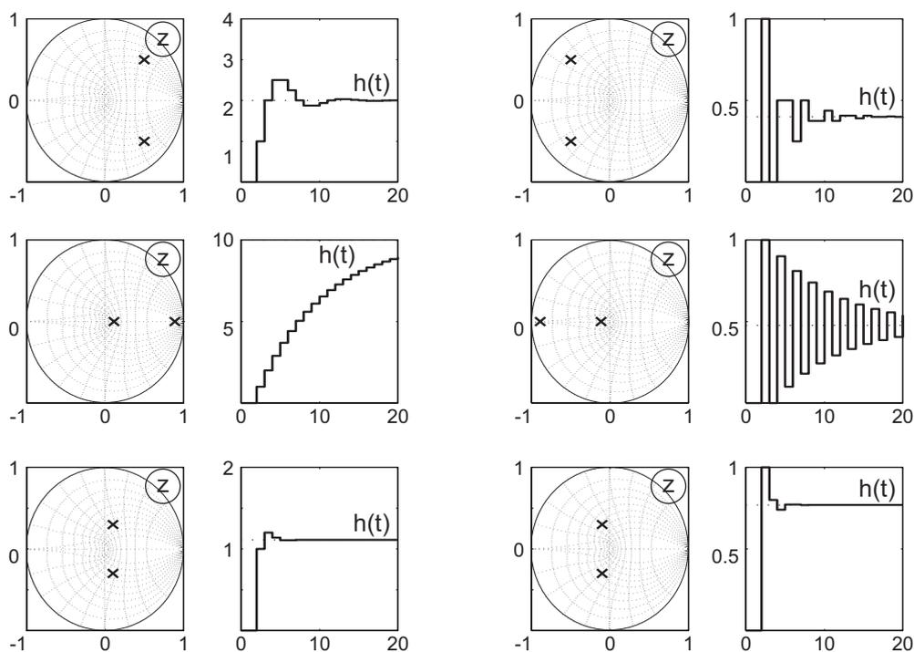
Bild 18.2: Sprungantworten charakteristischer Einschwingvorgänge
