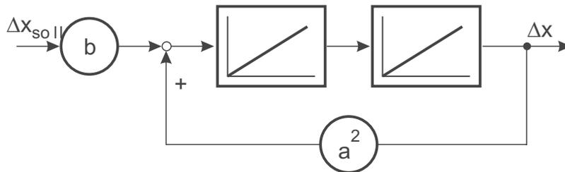
Bild 10.11: Blockschaltbild für Schwebekörper (linearisiert im Arbeitspunkt)
