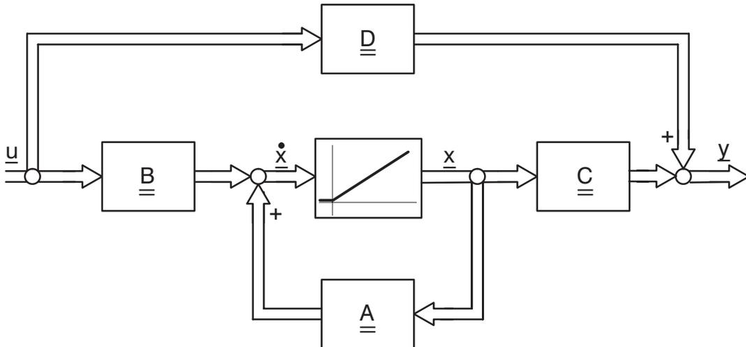
Bild 3.8: Zustandsraumdarstellung eines linearen Systems
