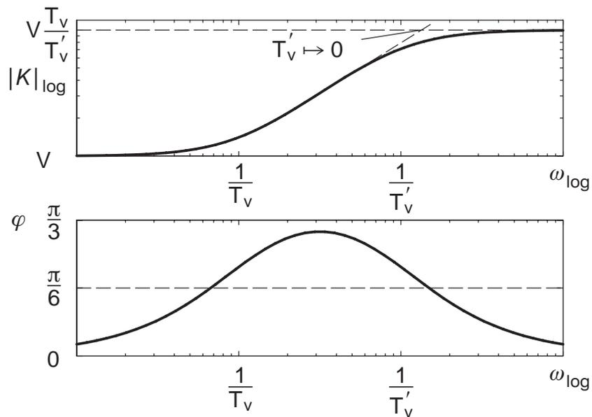
Bild 9.13: Bode-Diagramm PDT-Regler
