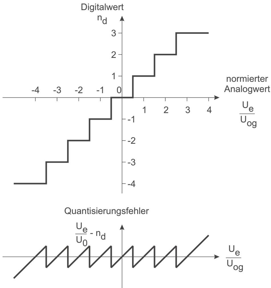
Bild 13.2: Amplituden-Quantisierungskennlinie
