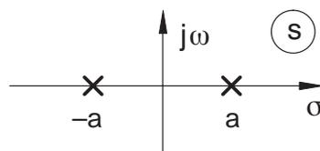
Bild 10.12: Polverteilung der linearisierten Regelstrecke
