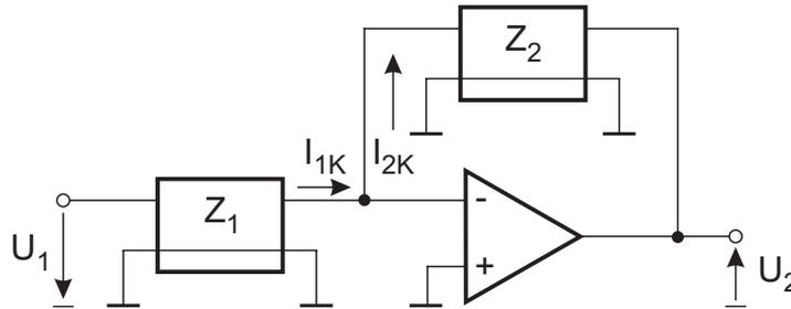
Bild 8.13: Vierpolbetrachtung eines Operationsverstärkers
