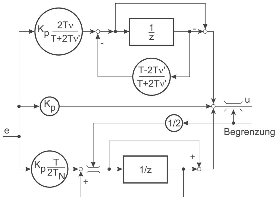
Bild 19.3: Diskreter realer PID-Regler: D-Anteil nach der Tustin-
