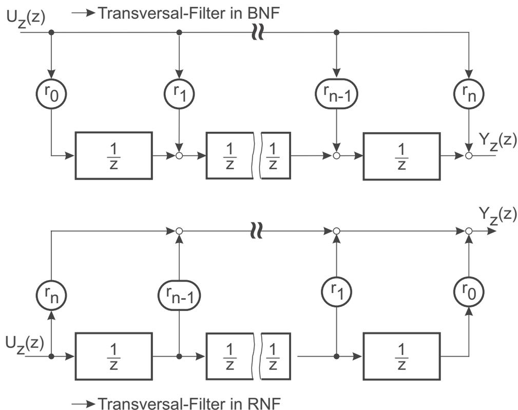
Bild 21.7: Transversalfilter in Beobachtungsnormalform (BNF) und in Regelungsnormalform (RNF)
