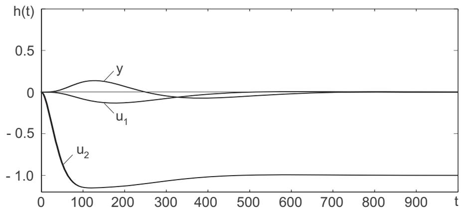
Bild 11.13: Sprungantwort bei Sprung der inneren Störgröße  $d_2$
