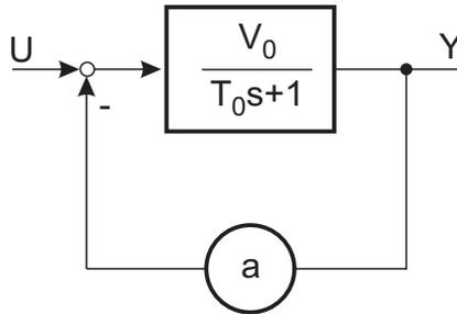
Bild 8.8: Blockschaltbild für gegengekoppelten Operationsverstärker mit  $a = 0 \dots 1$
