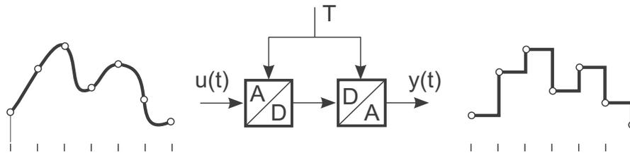
Bild 13.6: Entstehung einer Stufenfunktion durch den D/A-Wandler
