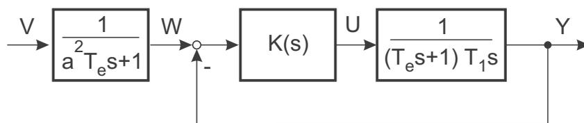
Bild 11.10: Führungsfilter bei Kaskadenstufen mit Integrator
