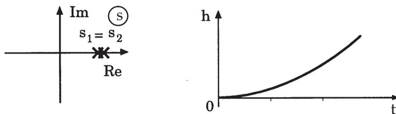
Bild 5.38: Pollage und Sprungantwort eines Systems zweiter Ordnung mit  $D = -1$
