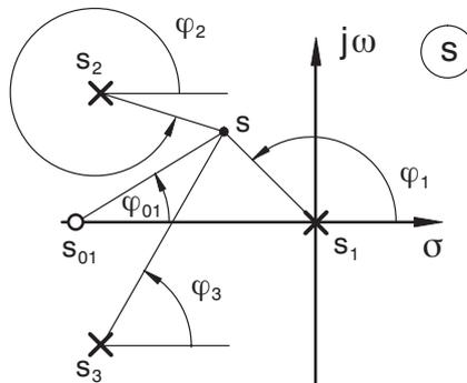
Bild 10.6: Graphische Bestimmung der Phasenbedingung
