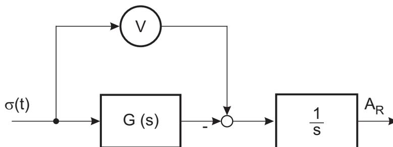
Bild 7.9: Blockschaltbild zur Ermittlung der Regelfläche
