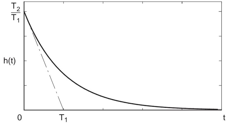
Bild 5.15: Sprungantwort einer  $DT_1$ -Strecke
