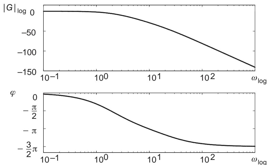
Bild 9.62: Bode-Diagramm  $PT_3$ -Strecke mit reellen Polen
