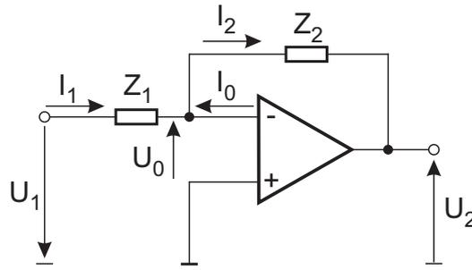
Bild 8.10: Invertierender Verstärker
