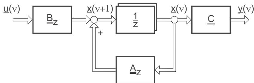
Bild 21.2: Zustandsdarstellung zeitdiskreter Systeme
