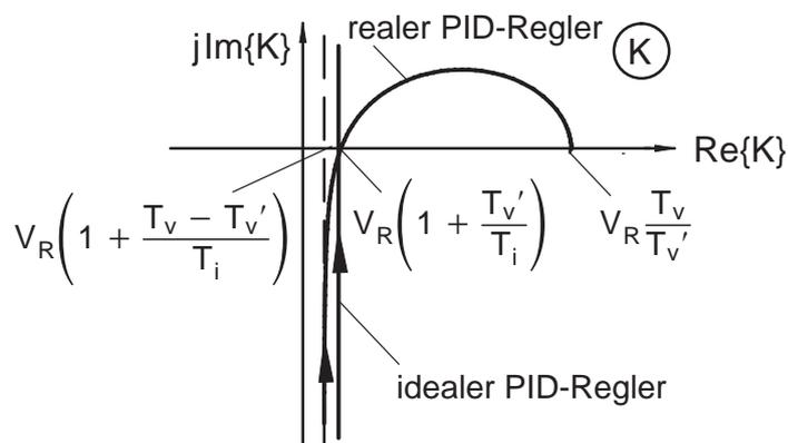
Bild 9.57: Ortskurve eines PID-Reglers (ideal und real)
