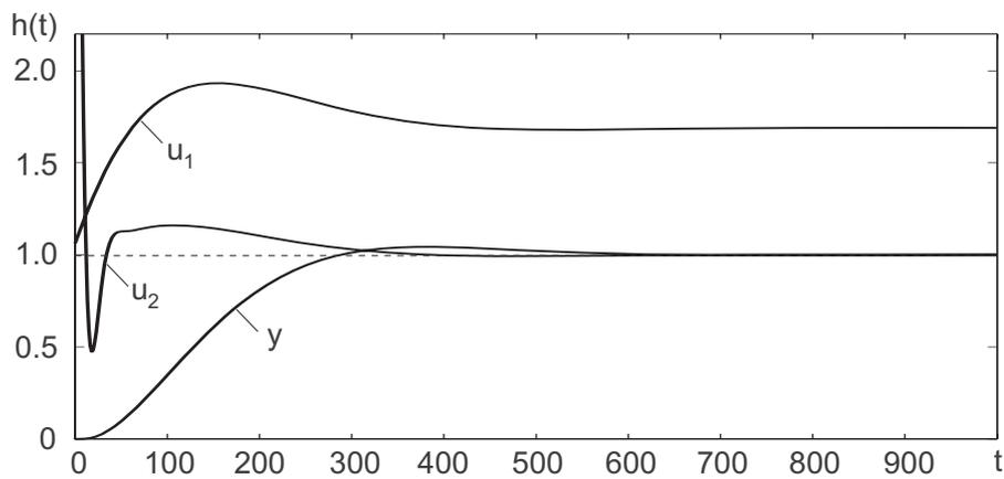
Bild 11.21: Sprungantwort bei Führungssprung
