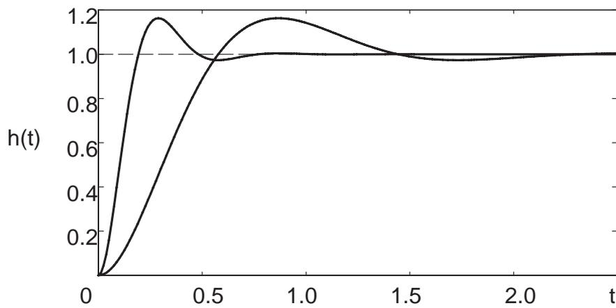
Bild 10.3: Einschwingverhalten bei Polen mit gleicher Dämpfung
