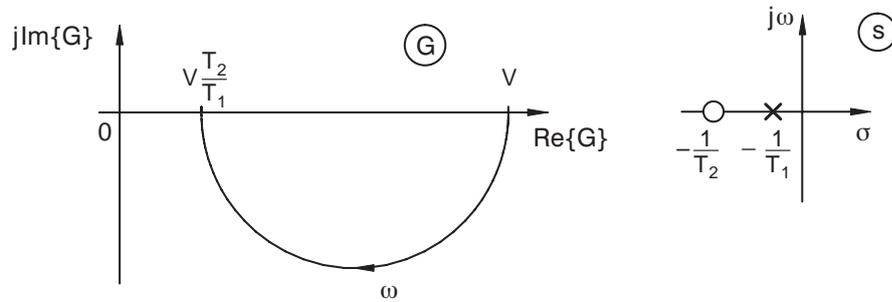
Bild 5.24: PTD-Verhalten ( $T_1 > T_2 > 0$ )
