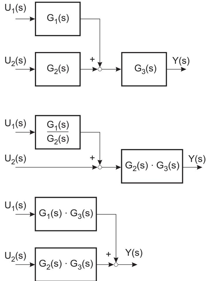
Bild 4.6: Verschiebung von Additionsstellen innerhalb eines Blockschaltbildes
