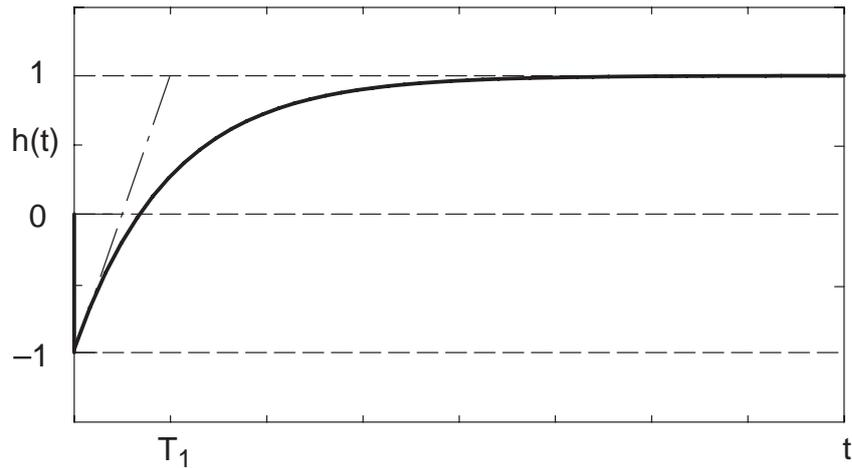
Bild 5.50: Sprungantwort eines Allpasses erster Ordnung
