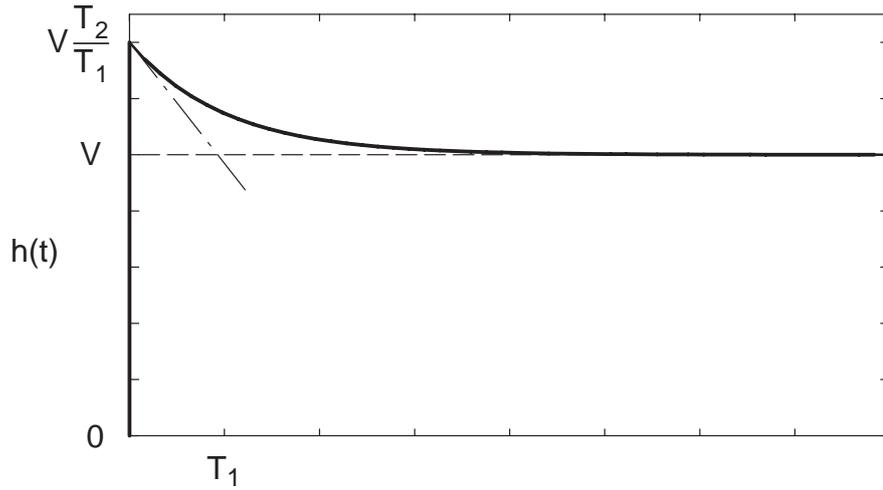
Bild 5.20: Sprungantwort eines PDT-Gliedes ( $T_2 > T_1 > 0$ )
