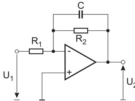
Bild 8.11: Operationsverstärkerschaltung für ein PT<sub>1</sub>-Glied
