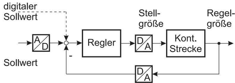
Bild 13.3: Regelung einer kontinuierlichen Strecke mit diskretem Regler
