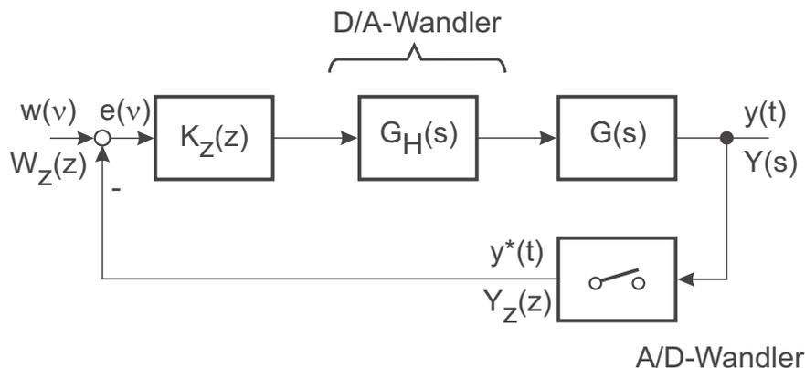
Bild 17.6: Zeitdiskreter Regler mit kontinuierlicher Strecke
