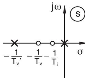
Bild 9.51: PID mit reellen Nullstellen
