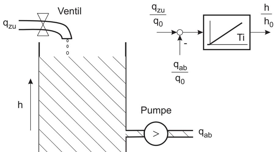
Bild 5.7: Anlageskizze und Blockschaltbild eines Behälters
