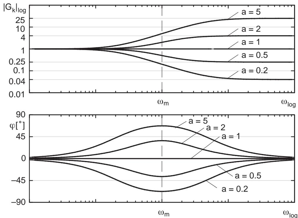
Bild 9.15: Bode-Diagramm für unterschiedliche  $a$
