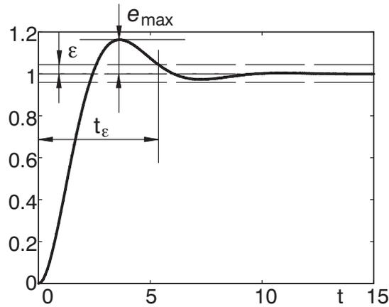
Bild 7.7: Kriterien zur Beurteilung eines Regelkreises im Zeitbereich
