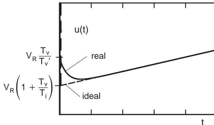
Bild 9.53: Sprungantwort des PID-Reglers
