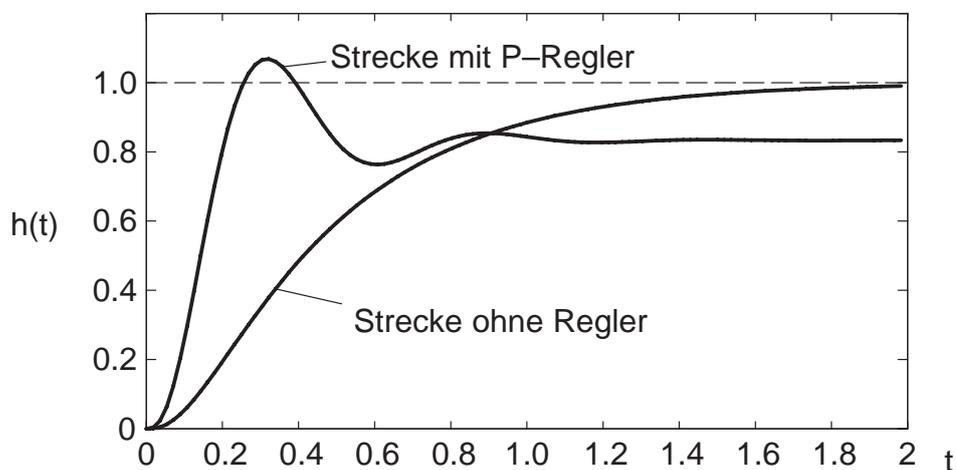
Bild 7.4: Sprungantwort der Führungsgröße  $w \rightarrow y$
