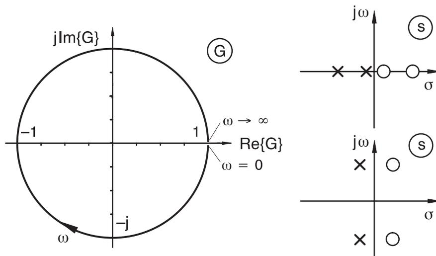
Bild 5.51: Ortskurve und Pol-/Nullstellenverteilung eines Allpasses zweiter Ordnung
