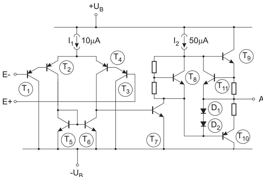
Bild 8.5: Schaltungsbeispiel eines bipolaren Bausteins
