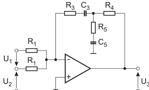
Bild 9.56: Operationsverstärkerschaltung PID
