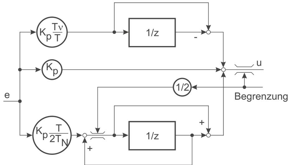
Bild 19.2: Diskreter idealer PID-Regler: D-Anteil nach der Ober-
