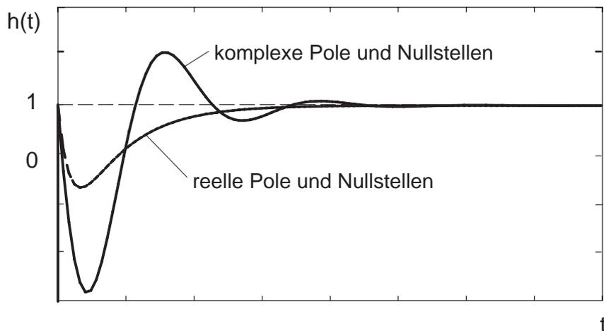
Bild 5.52: Sprungantwort eines Allpasses zweiter Ordnung
