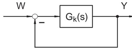
Bild 7.16: Blockschaltbild eines Regelkreises
