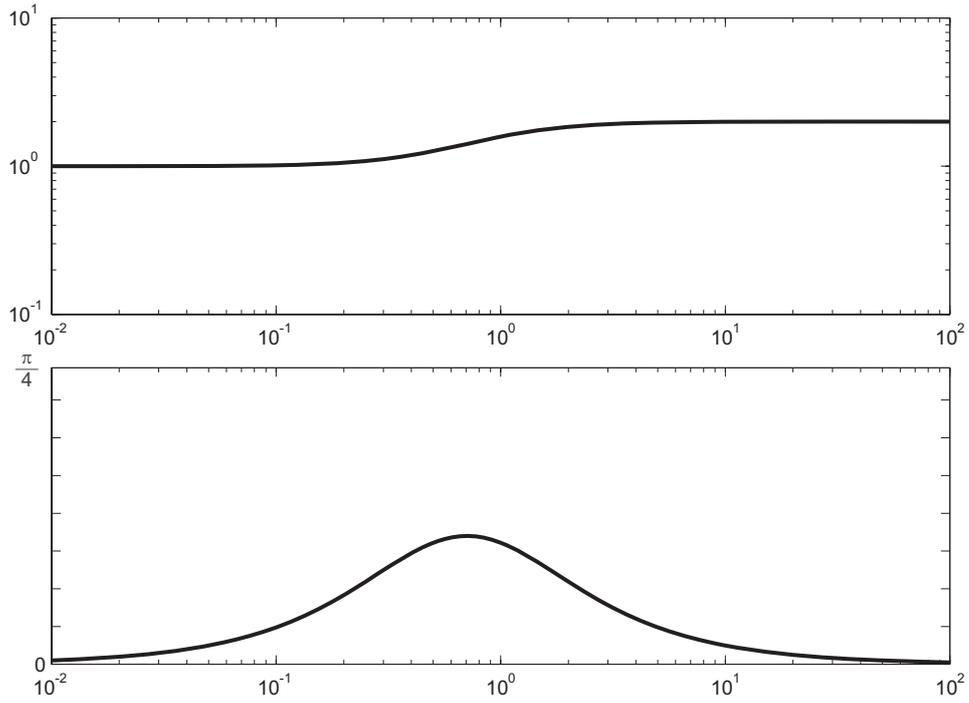
Bild 5.26: PDT-Verhalten ( $T_2 > T_1 > 0$ )
