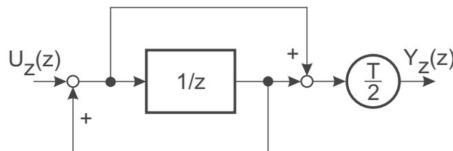
Bild 16.5: Diskreter Integrator nach der Trapezregel
