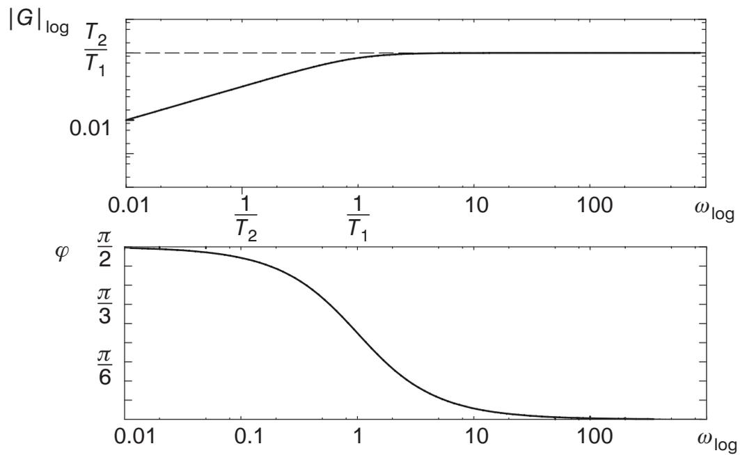
Bild 5.16: Bode-Diagramm eines  $DT_1$ -Gliedes
