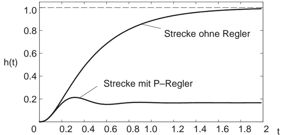
Bild 7.5: Sprungantwort der Störgröße  $d_1 \rightarrow y$
