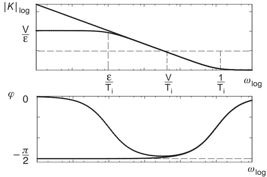
Bild 9.36: Bode-Diagramm eines PTD- und eines PI-Reglers
