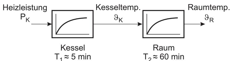
Bild 11.1: Einfaches Streckenmodell einer Heizung
