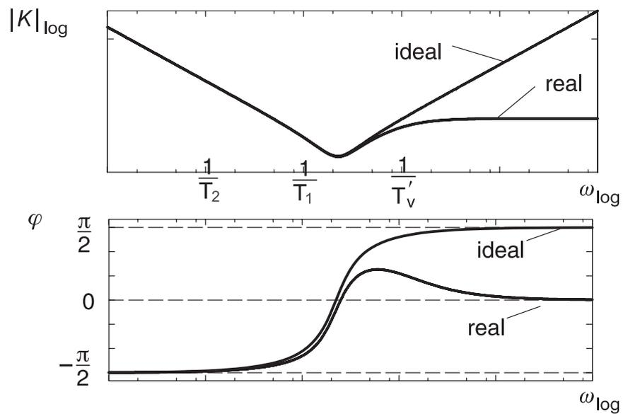
Bild 9.55: Bode-Diagramm PID – komplexe Nullstelle
