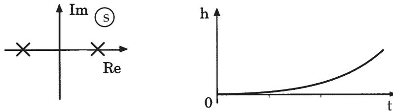
Bild 5.41: Pollage und Sprungantwort eines mitgekoppelten doppelten Integrators
