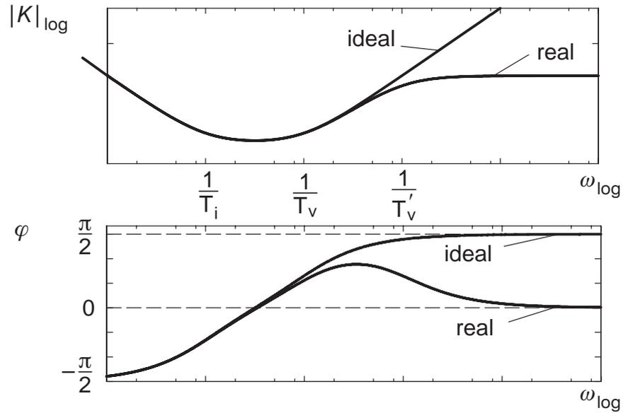
Bild 9.54: Bode-Diagramm PID – reelle Nullstelle
