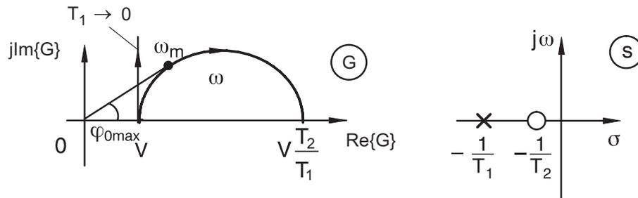
Bild 5.23: PDT-Verhalten ( $T_2 > T_1 > 0$ )
