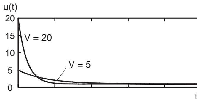
Bild 9.6: Stellgrößenverlauf für unterschiedliche Verstärkungen
