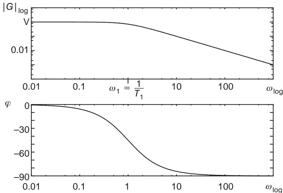
Bild 4.5: Bode-Diagramm eines Systems erster Ordnung
