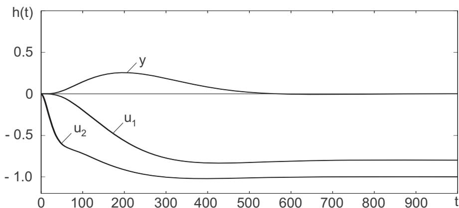
Bild 11.19: Sprungantwort bei Sprung der Störgröße  $d_1$
