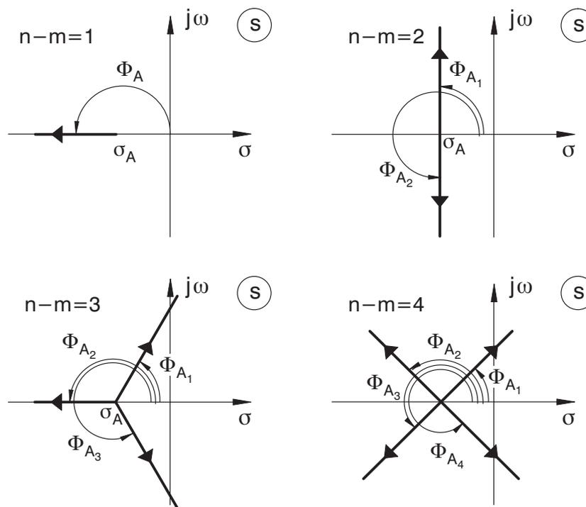
Bild 10.7: Zweige der Wurzelortskurve auf der reellen Achse
