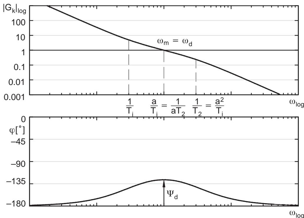
Bild 9.46: Bode-Diagramm „Symmetrisches Optimum“
