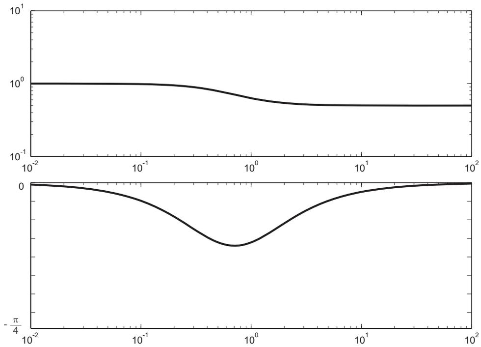
Bild 5.27: PTD-Verhalten ( $T_1 > T_2 > 0$ )
