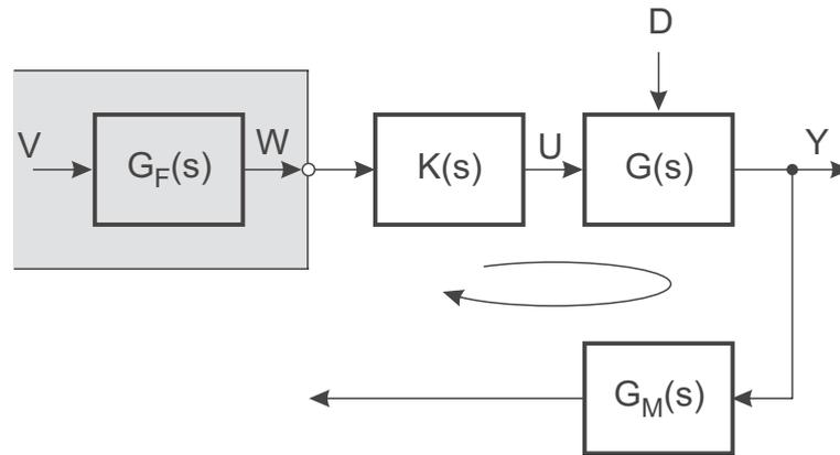
Bild 7.2: Kreisübertragungsfunktion  $G_k(s) = K(s) G(s) G_M(s)$
