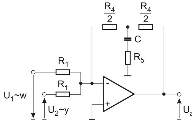
Bild 9.14: Operationsverstärkerschaltung für PD-Regler
