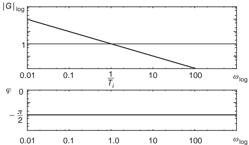
Bild 5.5: Bode-Diagramm eines Integrators
