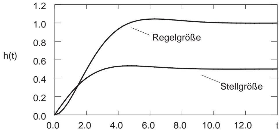
Bild 9.25: Sprungantwort des geschlossenen Kreises bei Führungsgrößenanregung mit  $D_g = 0.707$
