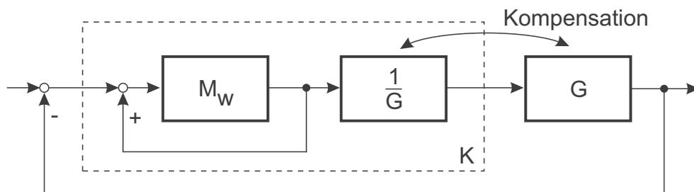
Bild 19.9: Regelkreis mit Kompensationsregler
