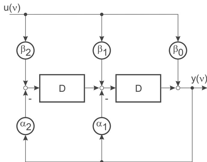
Bild 13.5: Blockschaltbild einer Differenzgleichung 2. Ordnung
