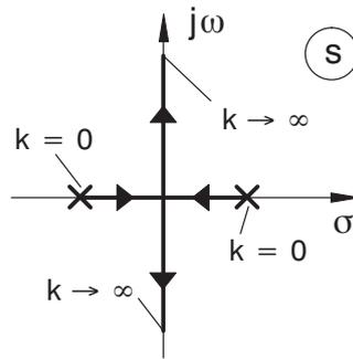
Bild 10.13: Wurzelortskurve für die linearisierte Strecke
