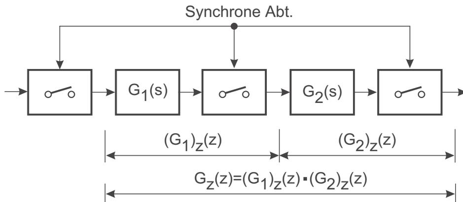
Bild 17.2: Reihenschaltung zeitdiskreter Systemteile
