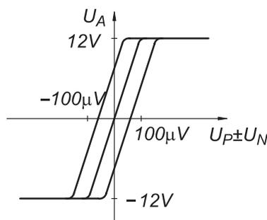
Bild 8.2: Ausgangs- und Differenzspannung eines Operationsverstärkers
