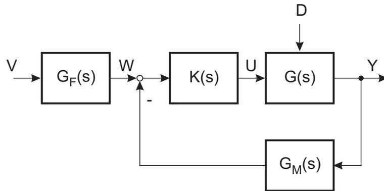
Bild 7.1: Blockschaltbild geschlossener Kreis mit Störung
