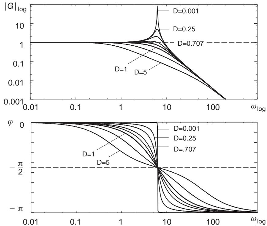
Bild 5.35: Bode-Diagramm  $PT_2$ -Glieder
