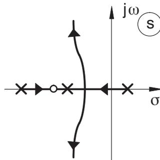
Bild 10.16: Wurzelortskurve mit Kompensation durch einen Vorhalt
