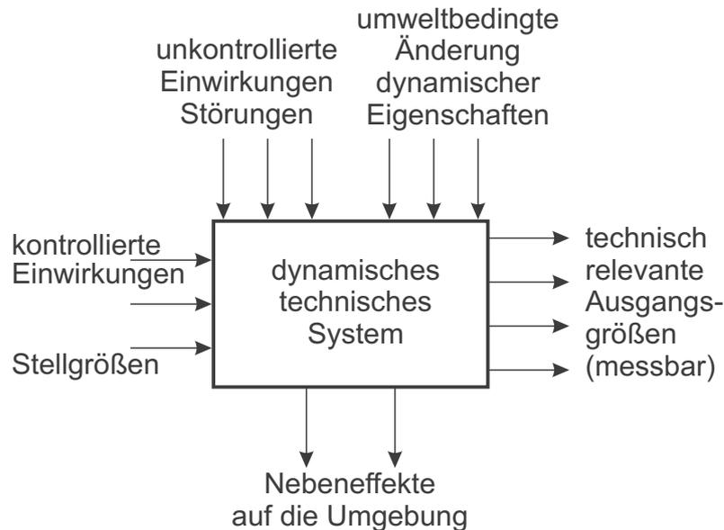
Bild 2.1: Dynamisches technisches System
