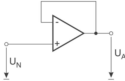
Bild 8.16: Spannungsfolger
