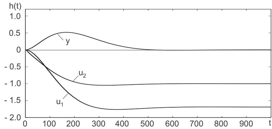
Bild 11.23: Sprungantwort bei Sprung der Störgröße  $d_2$
