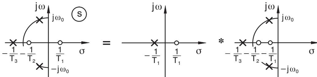
Bild 6.2: Aufspalten der Pole und Nullstellen einer Übertragungsfunktion in Allpass und Minimalphasenfunktion
