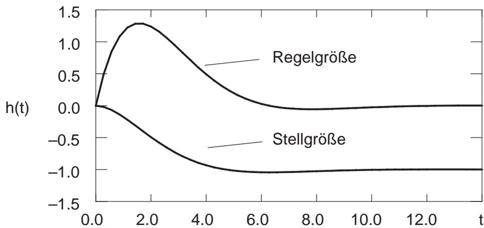
Bild 9.26: Sprungantwort des geschlossenen Kreises bei Störanregung
