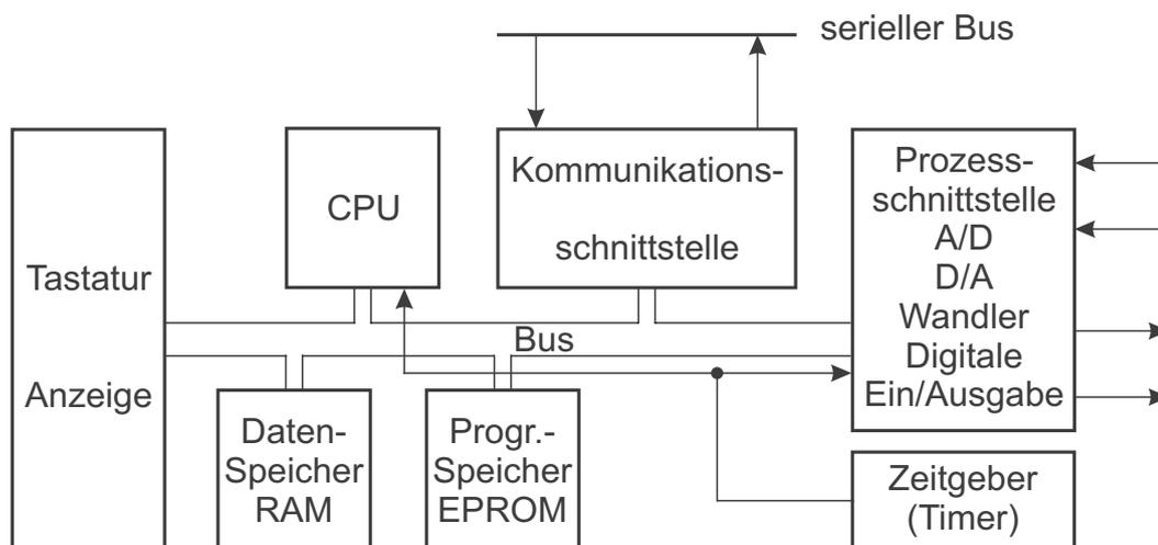
Bild 12.1: Mikrorechner für die regelungstechnische Anwendung
