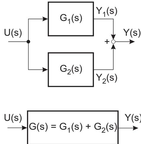
Bild 4.8: Parallelschaltung zweier linearer Blöcke
