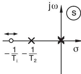
Bild 9.42: Pol-/Nullstellenverteilung für  $T_i < T_2$
