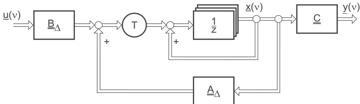
Bild 21.4: Zustandsdarstellung diskreter Systeme mit Delta-Transformation
