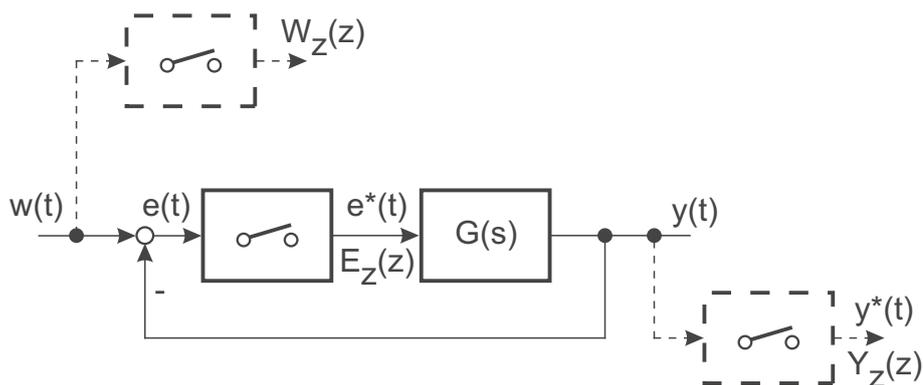
Bild 17.7: Regelkreis mit einem Abtaster
