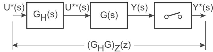
Bild 15.1: Entstehung einer Impuls-Übertragungsfunktion
