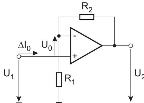
Bild 8.6: Operationsverstärker
