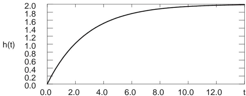
Bild 9.24: Sprungantwort einer  $PT_1$ -Strecke
