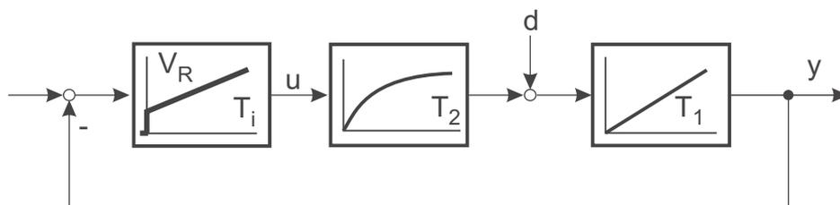
Bild 9.41: Drehzahlregelkreis
