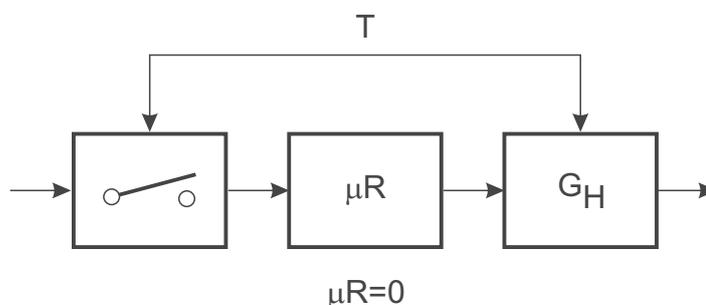
Bild 20.1: Synchroner Abtastung (A/D) und Ausgabe (D/A) und Rechenzeit Null
