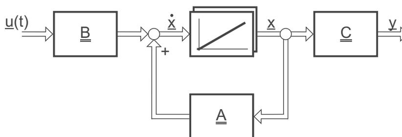
Bild 21.1: Zustandsdarstellung kontinuierlicher Systeme
