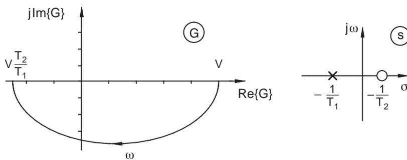
Bild 5.25: Allpasshaltige Verzögerung erster Ordnung ( $T_1 > 0, T_2 < 0$ )
