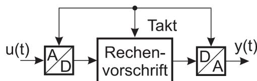
Bild 13.1: Schnittstellen bei diskreter Signalverarbeitung durch Digitalrechner
