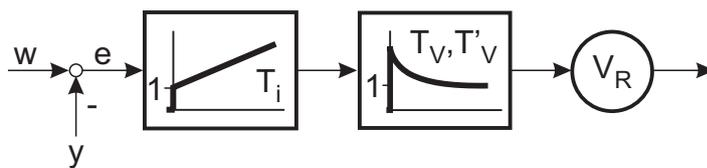
Bild 9.49: Zerlegung eines PID-Reglers in PI und PDT
