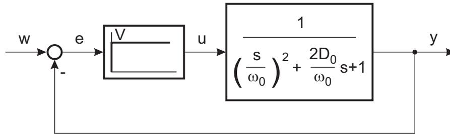
Bild 9.7: Blockschaltbild einer  $PT_2$ -Strecke mit P-Regler
