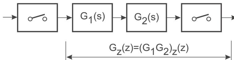
Bild 17.3: Reihenschaltung zweier kontinuierlicher Systemteile
