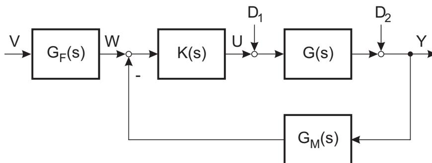
Bild 7.3: Blockschaltbild mit Angriff der Störung vor bzw. hinter der Strecke
