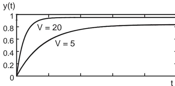
Bild 9.5: Sprungantworten für unterschiedliche Verstärkungen
