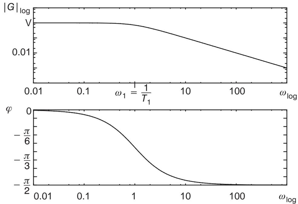
Bild 5.12: Bode-Diagramm PT<sub>1</sub>-Strecke
