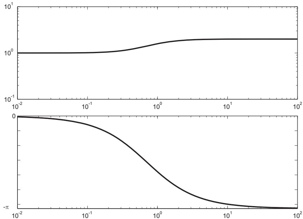
Bild 5.28: Allpasshaltige Verzögerung erster Ordnung ( $T_1 > 0, T_2 < 0$ )
