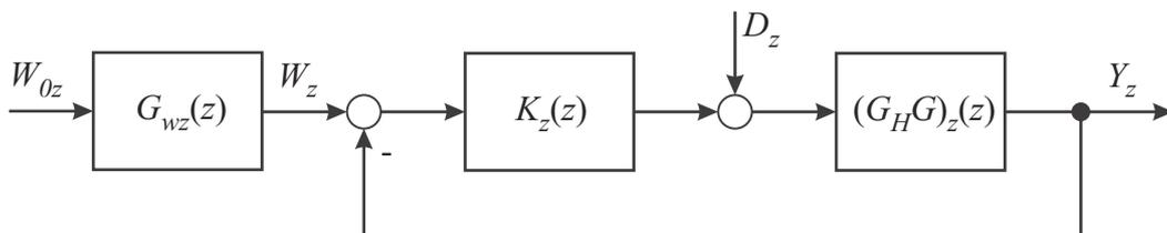
Bild 20.6: Geschlossener Kreis mit Führungsfilter
