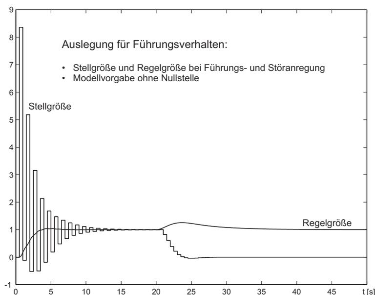
Bild 20.3: Sprungantwort und Stellgröße bei Modellfunktion ohne Nullstelle
