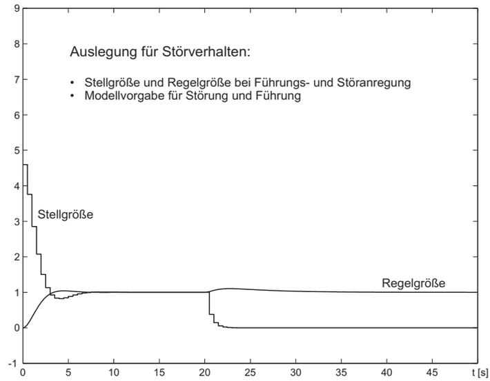
Bild 20.9: Sprungantwort und Stellgröße bei getrennter Modellvorgabe für Störung und Führung
