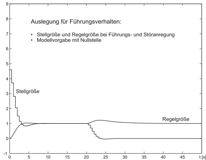
Bild 20.5: Sprungantwort und Stellgröße bei Modellfunktion mit Nullstelle
