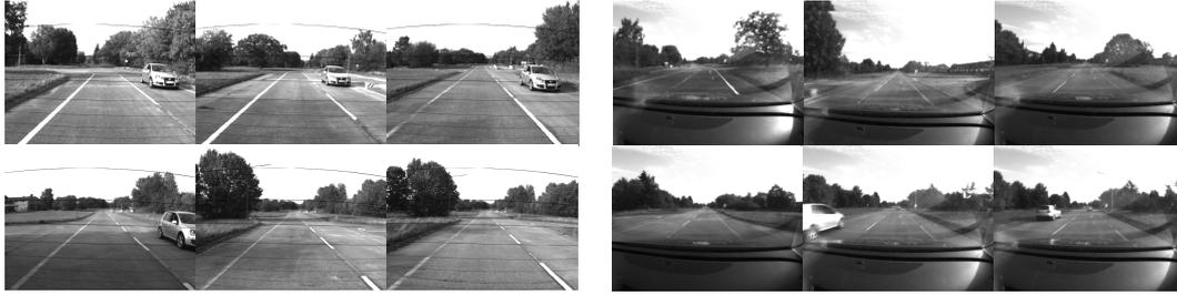
Abbildung 6: Videostream der Rück- (links) und Frontkamera (rechts) beim Abbrechen eines Fahrstreifenwechsels mit einem Verkehrsteilnehmer auf dem Nachbarfahrstreifen
