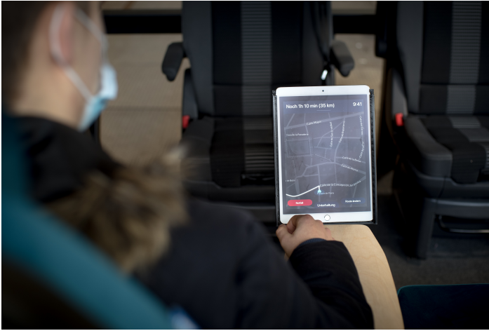
Abbildung 7.2: Erprobung von Bedienelementen mithilfe der im Vorjahr erstellten Sitzkiste
