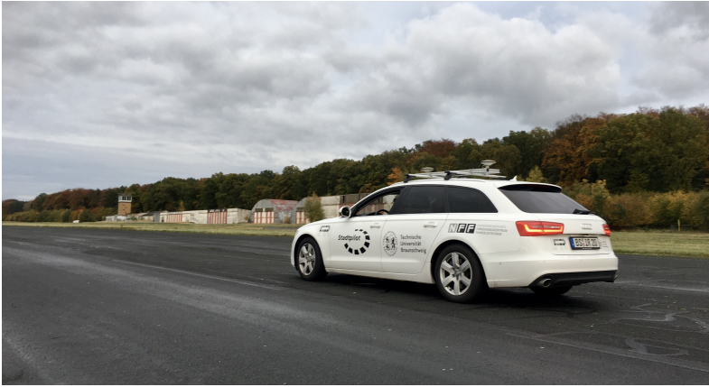
Abbildung 6.1: Der im Projekt eingesetzte Vehicle-In-The-Loop Versuchsträger auf dem Versuchsgelände während der Tests für eine abschließende Präsentation.
