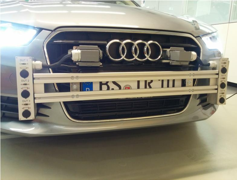
Abbildung 4.6: Device-Under-Test-Anschlüsse der Referenzsensorik
