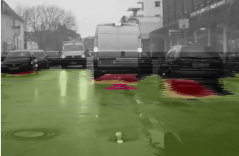
Abbildung 3.18: Belegungsgitter der einzelnen Zellzustände in einer innerstädtischen Verkehrsszene. Die statistisch genaue Befahrbarkeitswahrscheinlichkeit des Fahrschlauchs wird durch die beiden magentafarbenen Dreiecke dargestellt.
