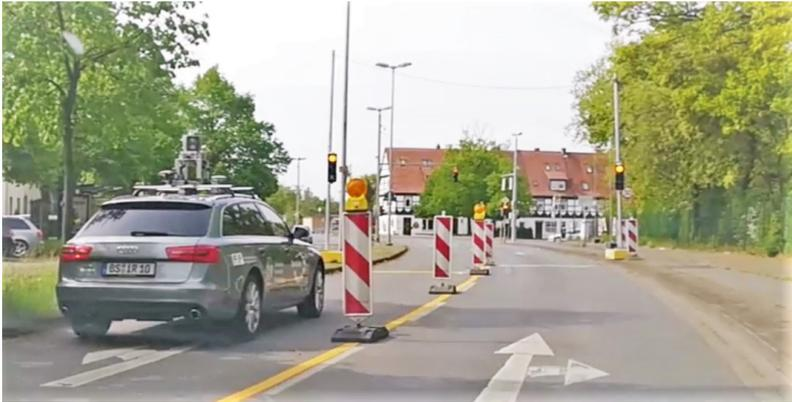
Abbildung 10.1: Versuchsträger Referenzsensorik („RefSens“) des Instituts für Regelungstechnik bei der Anfahrt auf die Kreuzung am Tostmannplatz im Bereich der Vorsortierung (auf dem rechten Fahrstreifen: manuell gesteuerte Fahrzeuge, auf dem linken Fahrstreifen: automatisierte Fahrzeuge)
