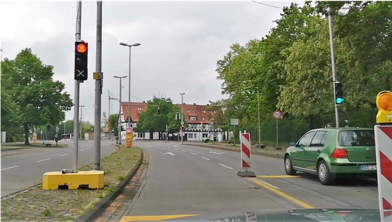
Abbildung 10.3: Vorsignalisierung an der Kreuzung am Tostmannplatz: die vorsortierten manuell gesteuerten Fahrzeuge auf dem rechten Fahrstreifen dürfen sich entsprechend der Vorsignalisierung der Kreuzung nähern (Ampel rechts: grün) während die automatisierten Fahrzeuge auf dem linken Fahrstreifen warten müssen (Ampel links: rot)
