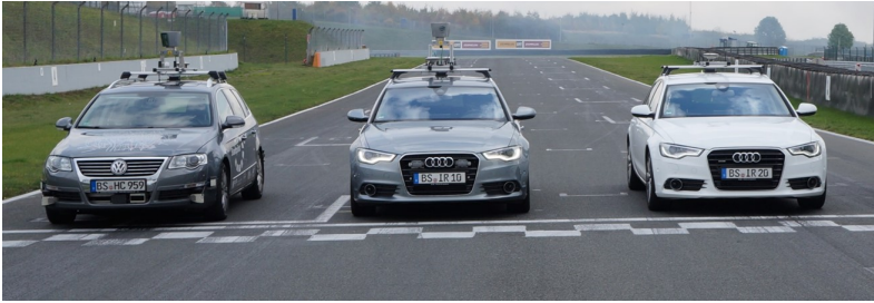
Abbildung 11.1: Versuchsträger des Instituts für Regelungstechnik, die im Digitalen Knoten 4.0 an einer Demonstrationsfahrt teilnehmen. Von links nach rechts: Leonie, Referenzsensorik ("RefSens") und Vehicle-in-the-Loop ("ViL")
