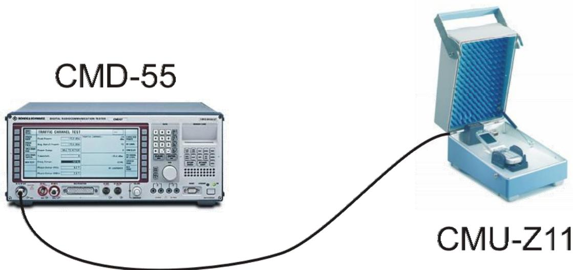
Abbildung 8: Die verwendeten Labormessgeräte CMD-55 und CMU-Z11
