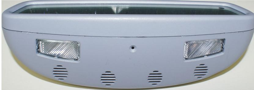
Abbildung 1: Mikrofonarray im Kfz-Innenspiegel
