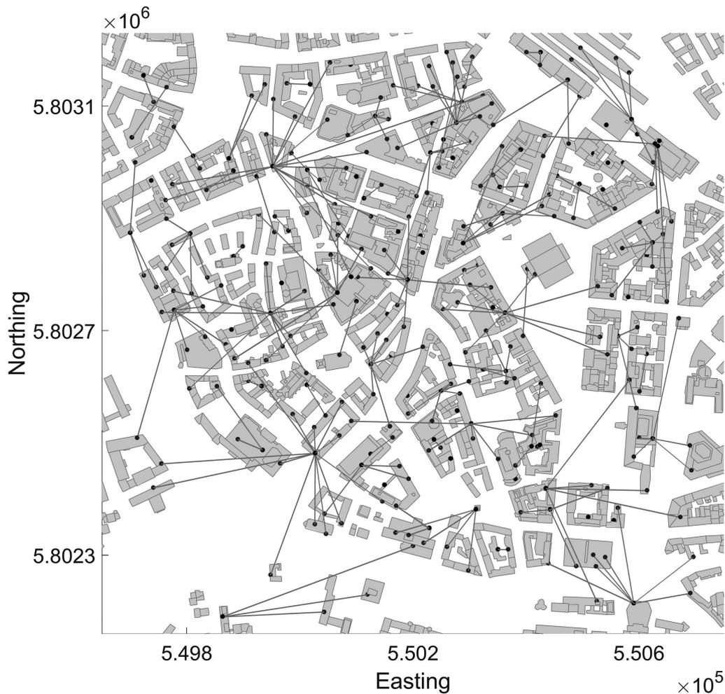
Abbildung 16: Automatisch ermittelte THz-Funkstrecken im Simulationsszenario Hannover für eine angenommene ultradichte Netzstruktur
