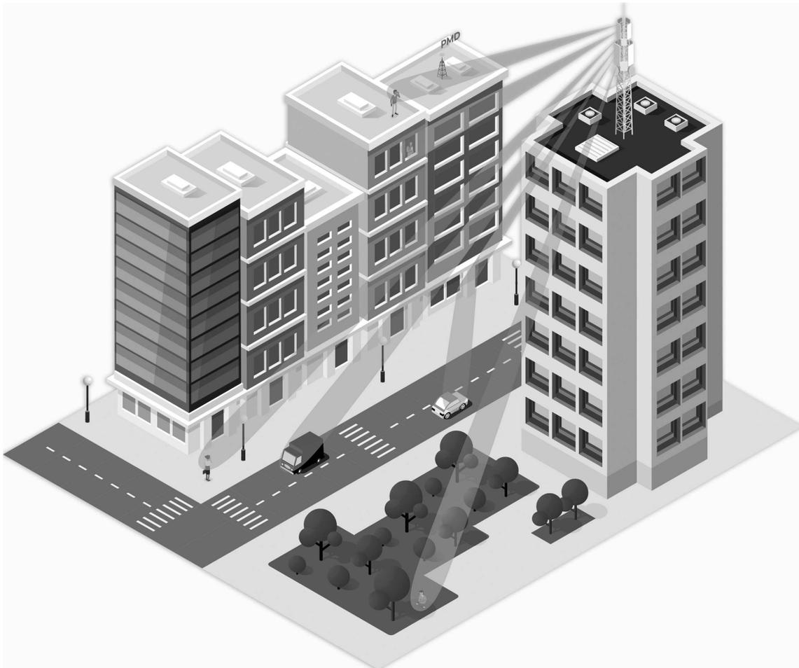
Abbildung 13: Abstrahlcharakteristiken der auf die jeweiligen Mobilfunknutzer mittels Strahlformung ausgerichteten Antennenkeulen
